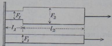
Spannungen muss die wirkende Zugkraft eine Arbeit verrichten, welche nach Gl. 5, S. 101 beträgt:
