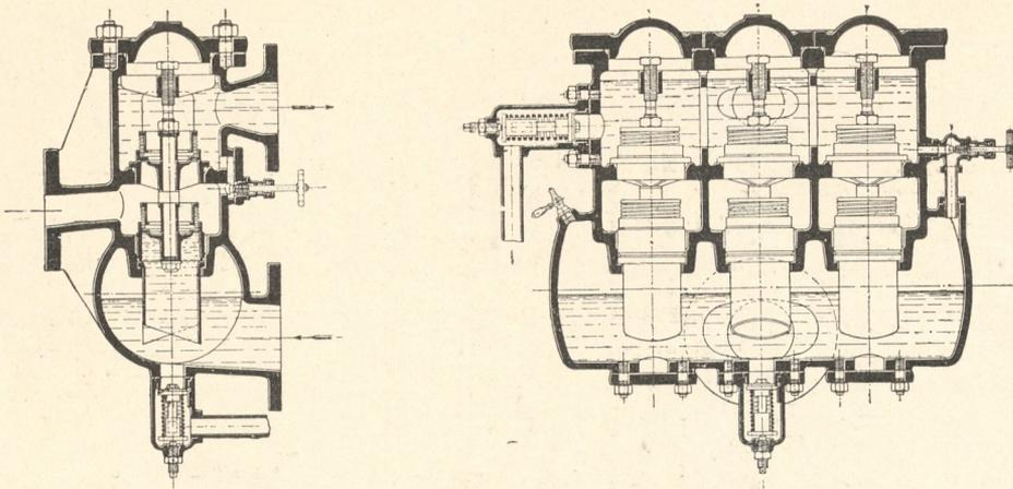
Fig. 581. Saug- und Druckventilkasten zur Drillingspumpe.
