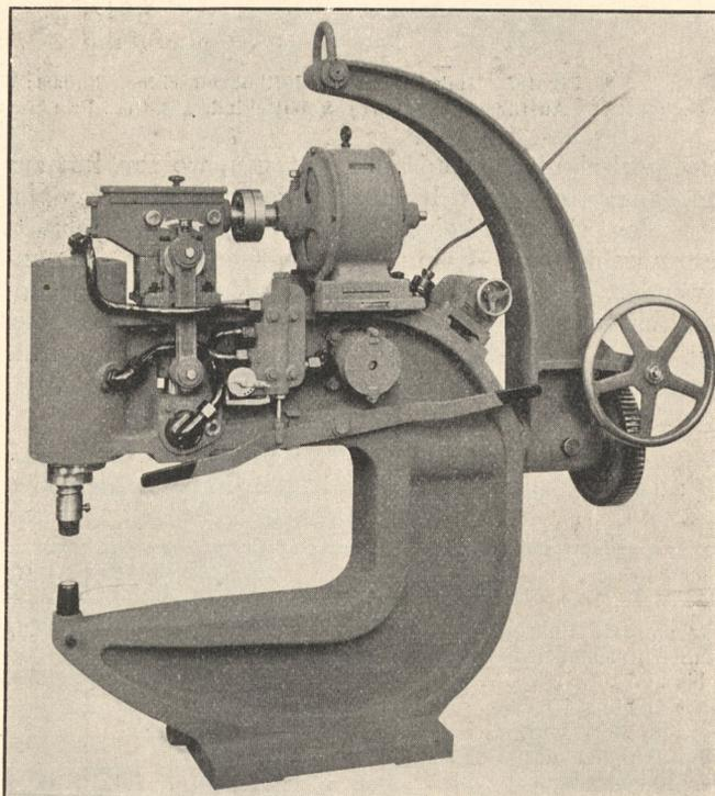
Fig. 486. Elektro-hydraulische Nietmaschine.
