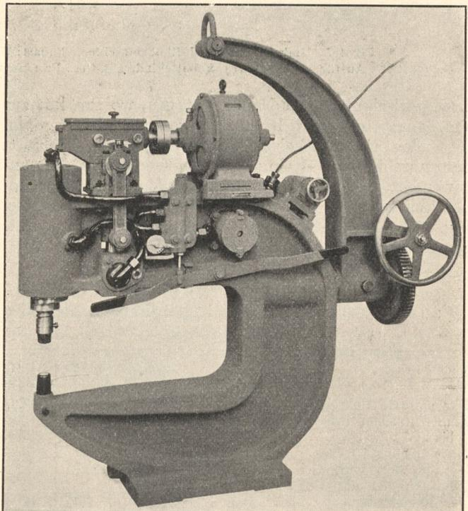
Fig. 486. Elektro-hydraulische Nietmaschine.
