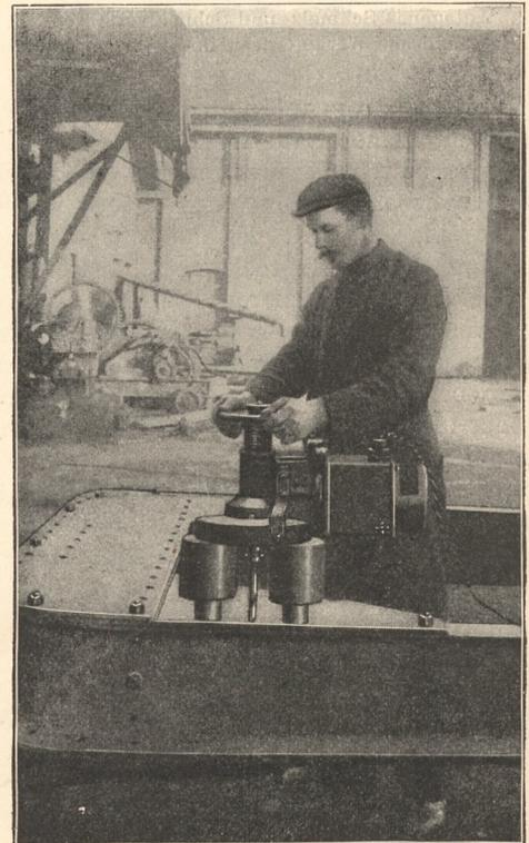
Fig. 478. Elektromagnetische Bohrmaschine, System Burckhardt.
