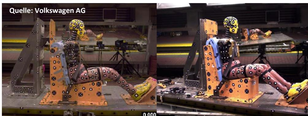
Abbildung 3-8: Versuchsaufbau der zwei Versuchskonstellationen der Methodenentwicklungsversuche mit gerader Schlittenplatte (links) und schräger Schlittenplatte (rechts)
