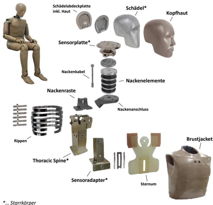
Abbildung 3-2: Physisches Modell: Aufbau eines Hybrid III 50% (Kopf, Nacken, Torso) [Humanetics, 2017b]
