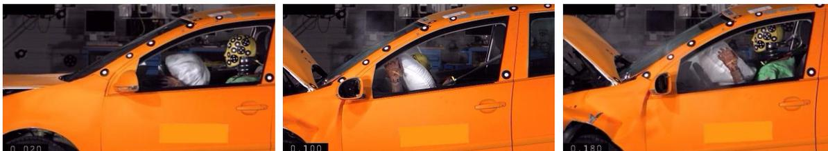
Abbildung 1-1: Bildsequenz der Dummykinematik im Crashtest [Raguse K. et al., 2012]
