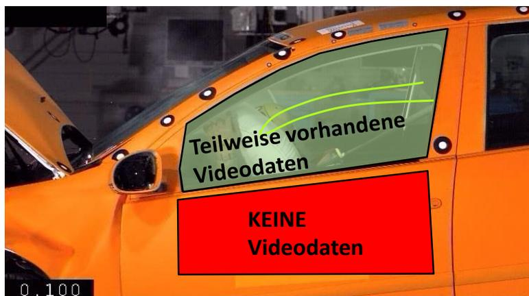
Abbildung 1-2: Problematik bei der Bestimmung der Thoraxtrajektorie im Realversuch [Raguse K. et al., 2012]
