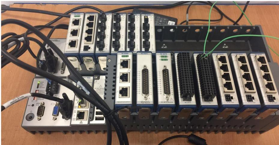
Abbildung Anhang A.2-1: Realtime Controller mit verbauten Modulen
