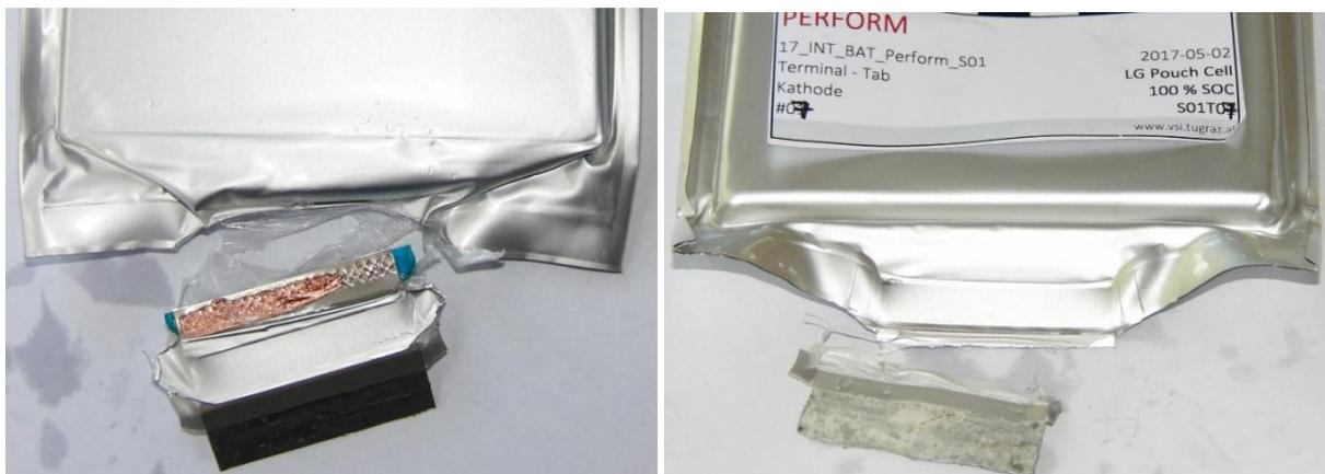
Abbildung 6-34: Schadensvergleich (links: Anodenseite; rechts: Kathodenseite)
