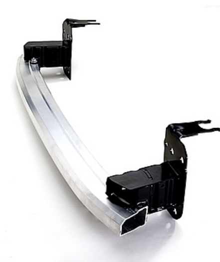
Abbildung 3.2: Beispiel für ein Crash Management System in der Fahrzeugfront [45]
