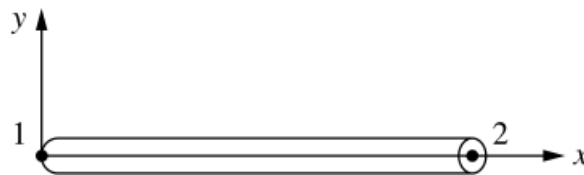
Abbildung 4.2: 1D Elemente: Beam Element mit 2 Integrationspunkten [33, S. 10]
