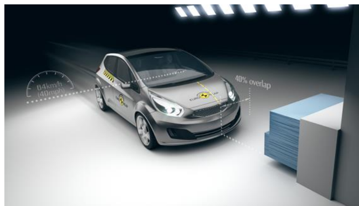
Abbildung 3-8: Versuchskonstellation für den Frontalaufprall gegen deformierbare Barriere nach EURO-NCAP [EURO-NCAP, 2017]
