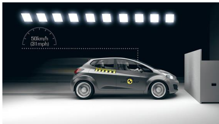
Abbildung 3-7: Versuchskonstellation für den Frontalaufprall gegen eine starre Wand nach EURO-NCAP [EURO-NCAP, 2017]
