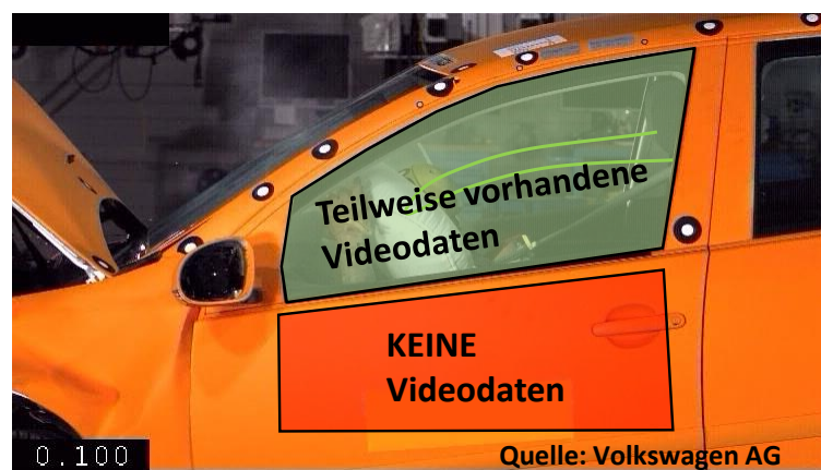
Abbildung 1-1: Problematik der Bestimmung der Dummykinematik mittels dreidimensionaler Filmanalyse im Crashtest [Moser J., 2017]
