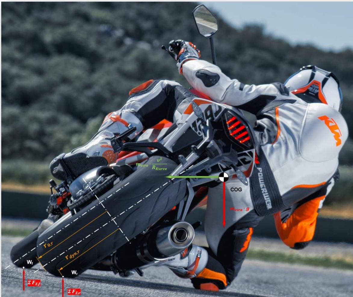
Abbildung 4-2; Latsch und Radaufstandspunkt bei Kurvenfahrt, Bild KTM 1290 SUPER DUKE R (KTM AG, 2017)
