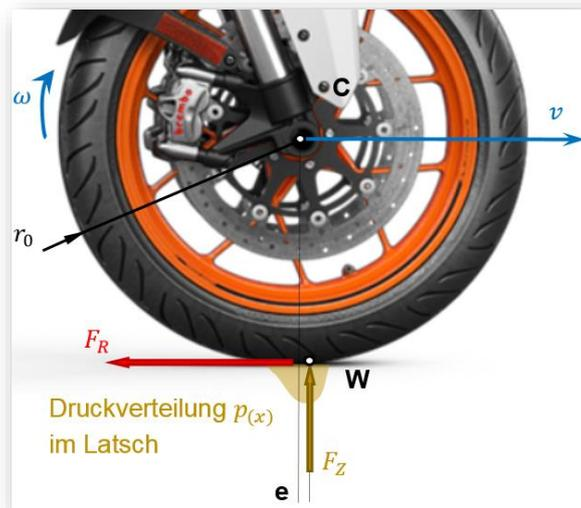
Abbildung 2-6; Rollwiderstand und Kräfte am Vorderrad, Bild des Vorderrades (KTM AG, 2017)
