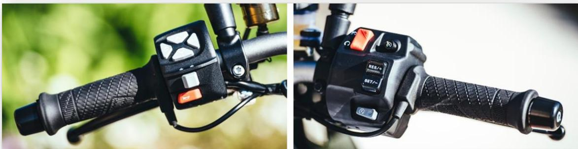
Abbildung 4-3; Bedieneinheiten am Lenker, Bilder (KTM AG, 2017)
