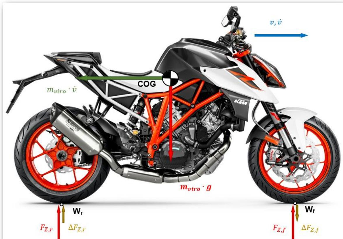
Abbildung 2-3; statische (rot) und dynamische (gelb) Radlasten am Motorrad, Bild KTM 1290 SUPER DUKE R (KTM AG, 2017)
