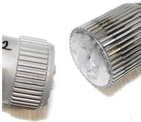
*Abbildung 9: Eindeutige Zuordnung einer Kerbe zum Bruch, hier ein umlaufender Einstich zwischen zwei Steckverzahnungen*
