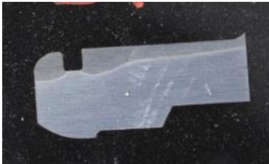
Abbildung 59: Induktionshärtung im Nutgrund
