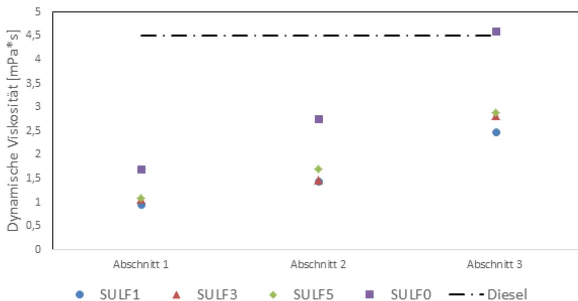
Abb. 7-19: Dynamische Viskosität der organischen Produktphase über die Versuchsdauer
