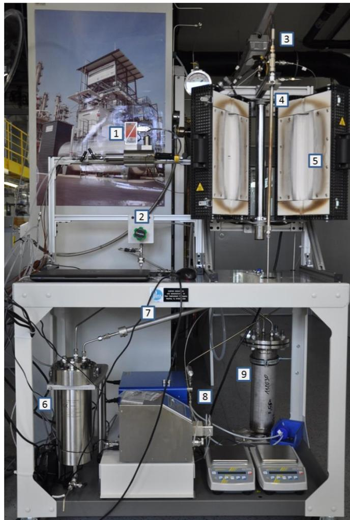
Abb. 5-1: Aufbau der Versuchsanlage: (1) Massendurchflussregler, (2) Druckregelungsventil, (3) Thermosensor, (4) Rohrreaktor, (5) Heizmantel, (6) Produktbehälter, (7) Kühler, (8) Hochdruckpumpe, (9) Expansionsbehälter
