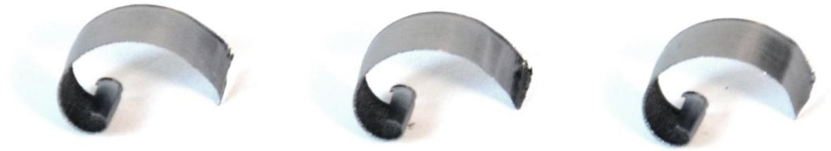
Abbildung 41: Späne Seco Square 6 mit XNEX 080608TR-M13 (MP2500) bei  $v_c=300\text{ m/min}$  und  $a_e=27,5\text{ mm}$ , Quelle: Eigene Darstellung.
