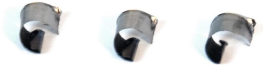
Abbildung 56: Späne Sandvik CoroMill 390 mit R390-11 T3 08M-PM (4230) bei  $v_c=300\text{m/min}$  und  $a_e=15\text{mm}$ , Quelle: Eigene Darstellung.
