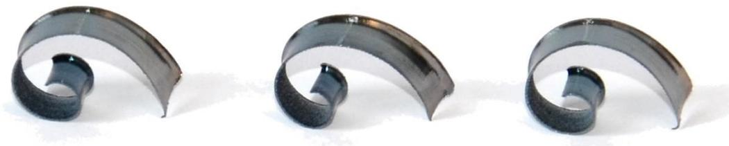
Abbildung 98: Späne Ceratizit MaxiMill 491 ohne KSS bei  $v_c=300\text{ m/min}$ , Quelle: Eigene Darstellung.
