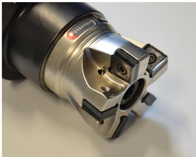
Abbildung 33: Verschleiß am Grundkörper, Quelle: Eigene Darstellung.
