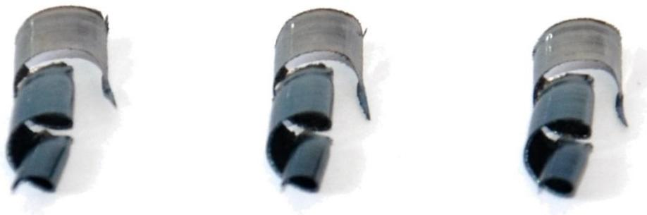
Abbildung 50: Späne Ceratizit MaxiMill 211 mit XDKT 11T308SR-M50 (CTPP230) bei  $v_c=300\text{m/min}$  und  $a_e=35\text{mm}$ , Quelle: Eigene Darstellung.
