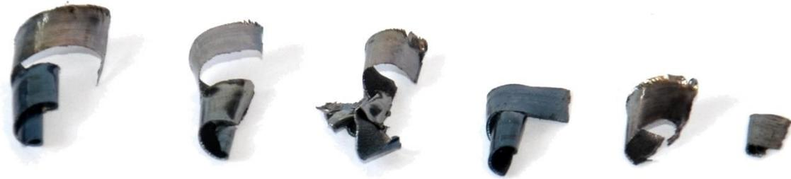
Abbildung 53: Späne Sandvik CoroMill 390 mit R390-11 T3 08M-PM (4230) bei  $v_c = 300 \text{ m/min}$  und  $a_e = 35 \text{ mm}$ , Quelle: Eigene Darstellung.
