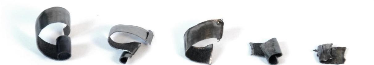
Abbildung 76: Späne Ingersoll Gold-Max 8 mit SGM-44R001 (IN4030) bei  $v_c=300\text{ m/min}$  und  $a_e=35\text{ mm}$ , Quelle: Eigene Darstellung.
