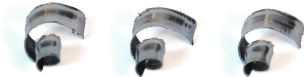
Abbildung 63: Späne Tungaloy TPW13 mit SWMT1304PDPR-MJ (T3130) bei  $v_c=300\text{m/min}$  und  $a_e=35\text{mm}$ , Quelle: Eigene Darstellung.
