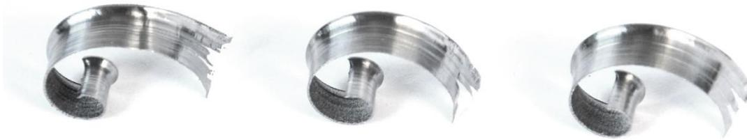
Abbildung 99: Späne Ceratizit MaxiMill 491 mit KSS bei  $v_c=300$  m/min, Quelle: Eigene Darstellung.
