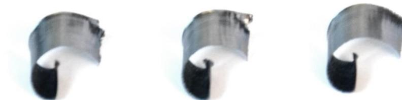
Abbildung 59: Späne Sandvik CoroMill 390 mit R390-11 T3 08M-PM (1030) bei  $v_c=300$  m/min und  $a_e=15$  mm, Quelle: Eigene Darstellung.
