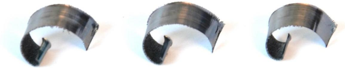
Abbildung 72: Späne Tungaloy TPM11 mit LMMU110708PNER-MJ (T3130) bei  $v_c=300$  m/min und  $a_e=20$  mm, Quelle: Eigene Darstellung.
