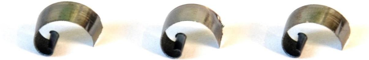
Abbildung 77: Späne Ingersoll Gold-Max 8 mit SGM-44R001 (IN4030) bei  $v_c=300$  m/min und  $a_e=20$  mm, Quelle: Eigene Darstellung
