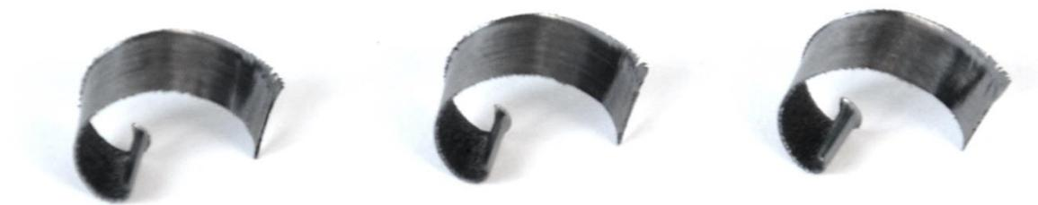
Abbildung 74: Späne Tungaloy TPM11 mit LMMU110708PNER-MJ (AH725) bei  $v_c=300$  m/min und  $a_e=20$  mm, Quelle: Eigene Darstellung.
