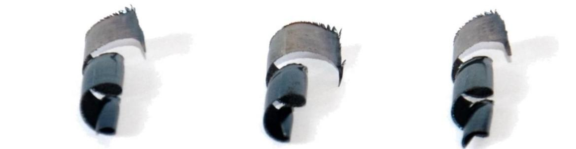
Abbildung 48: Späne Ceratizit MaxiMill 211 mit XDKT 11T308SR-M50 (CTCP230) bei  $v_c=300\text{m/min}$  und  $a_e=35\text{mm}$ , Quelle: Eigene Darstellung.
