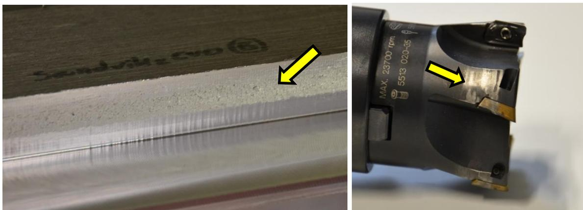
Abbildung 52: Erzeugte Schulter mit verschweißsten Spänen und Fräsergrundkörper mit Verschleiß, Quelle: Eigene Darstellung.
