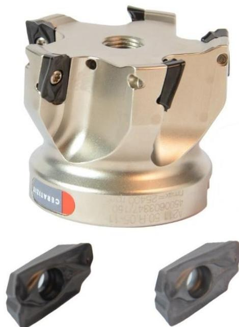
Abbildung 20: Ceratzit MaxiMill 211 und XDKT 11T308SR-M50 Wendeschneidplatten, Quelle: Eigene Darstellung.
