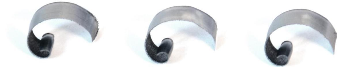
Abbildung 46: Späne Seco Square 6 mit XNEX 080608TR-M13 (F40M) bei  $v_c=300\text{m/min}$  und  $a_e=27,5\text{mm}$ , Quelle: Eigene Darstellung.
