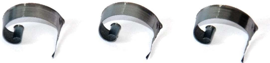
Abbildung 38: Späne Iscar HELIDO S890 mit S890 SNMU 1305PNTR (IC 5400) bei  $v_c=300$  m/min und  $a_e=35$  mm, Quelle: Eigene Darstellung.
