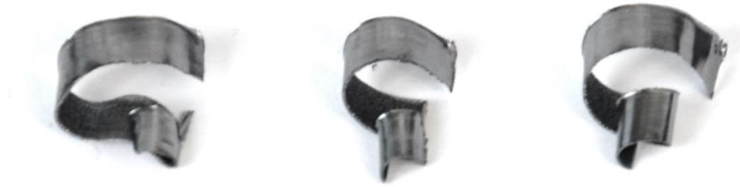
Abbildung 69: Späne Tungaloy TPM11 mit LMMU110708PNER-MJ (T3130) bei  $v_c = 300$  m/min und  $a_e = 35$  mm, Quelle: Eigene Darstellung.
