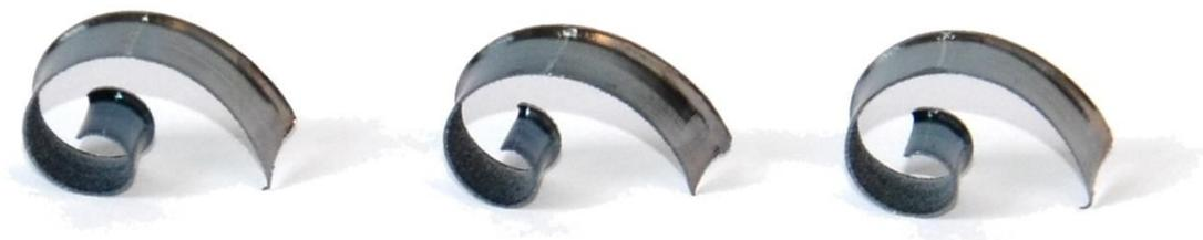
Abbildung 34: Späne Ceratizit MaxiMill 491 mit SNHU 120408SR-M50 (CTCP230) bei  $v_c=300\text{ m/min}$  und  $a_e=35\text{ mm}$ , Quelle: Eigene Darstellung.
