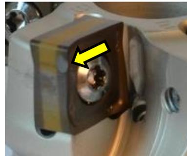
Abbildung 37: Ausbruch der Schneidkante nach 6,8 m Fräslänge, Quelle: Eigene Darstellung.
