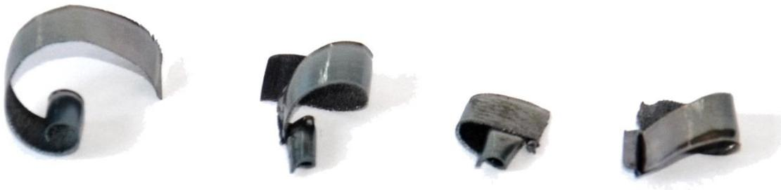
Abbildung 40: Späne Seco Square 6 mit XNEX 080608TR-M13 (MP2500) bei  $v_c=300\text{ m/min}$  und  $a_e=35\text{ mm}$ , Quelle: Eigene Darstellung.
