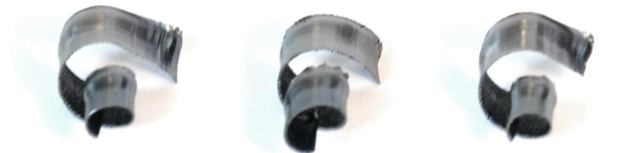
Abbildung 67: Späne Tungaloy TPW13 mit SWMT1304PDPR-MJ (AH120) bei  $v_c=300\text{m/min}$  und  $a_e=35\text{mm}$ , Quelle: Eigene Darstellung.
