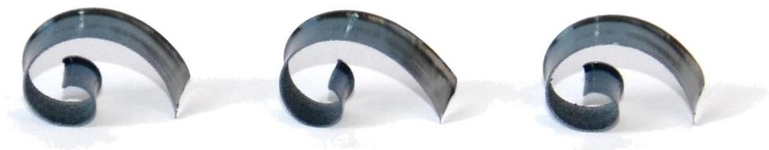
Abbildung 35: Späne Ceratizit MaxiMill 491 mit SNHU 120408SR-M50 (CTPP235) bei  $v_c=300\text{ m/min}$  und  $a_e=35\text{ mm}$ , Quelle: Eigene Darstellung.
