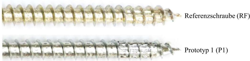
**Abbildung 2-3: Gewinde und Spitze von Referenzschraube und Prototyp 1 (Reichinger, 2017)**
