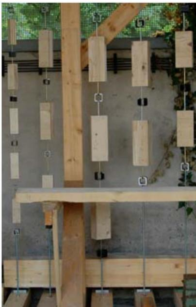
**Abbildung 1-19: Versuchsaufbau der Langzeitversuche axial beanspruchter Holzbauschrauben (Uibel und Blaß, 2013)**
