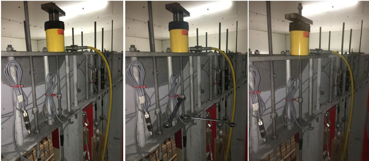
**Abbildung 2-9:** links: hydraulischer Anspannvorgang mittels Hydraulikzylinder, Mitte: manuelles Nachspannen mittels Schraubenschlüsseln (der obere Schraubenschlüssel dient zum Kontern), rechts: Ablassen des Hydraulikzylinders (die Kraft bleibt in der Kette, da zuvor manuell nachgespannt wurde)
