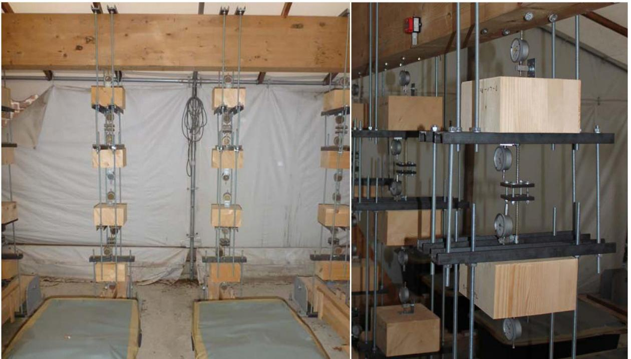
Abbildung 1-20: Versuchsaufbau Ausziehversuche (Koj und Trautz, 2016)
