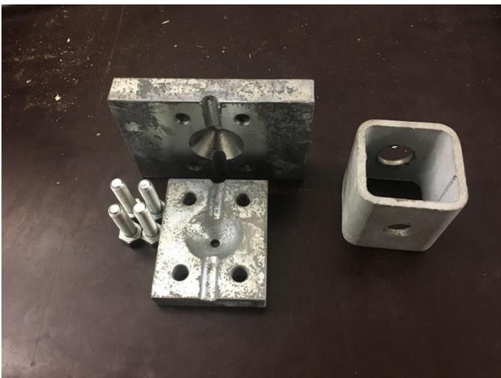
Abbildung 2-8: Verbindungselement zur Koppelung der Prüfkörper (links) und als Koppelungselement zur Anbindung der Prüfkörper an die Gewindestangen
