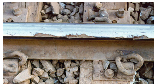
(b) Sehr starkes Shelling an der Schiene [8]
