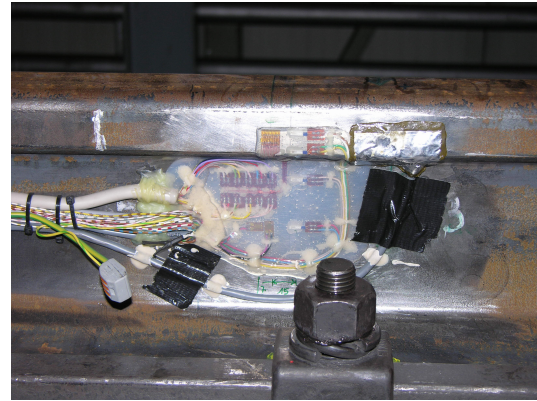
(a) Gesamter Prüfstand der voestalpine Schienen GmbH (b) DMS und Temperatursensoren am Prüfstand der voestalpine Schienen GmbH
