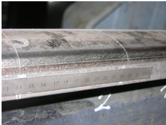
(a) Aufnahme von HCs an der Schiene
