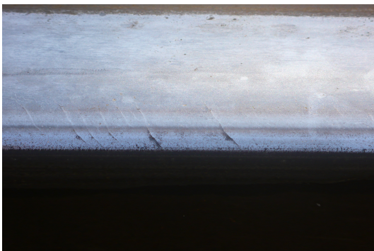
(c) Beispiel für erstes Auftreten von HC
