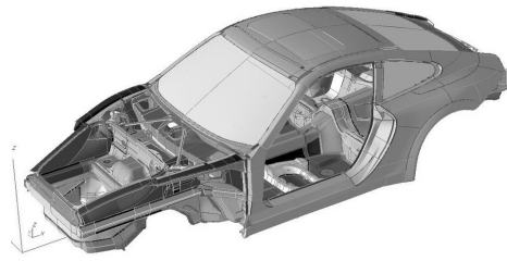
Abb. 4.41: Rohbaumodell eines PKW in SFE-CONCEPT [97]
