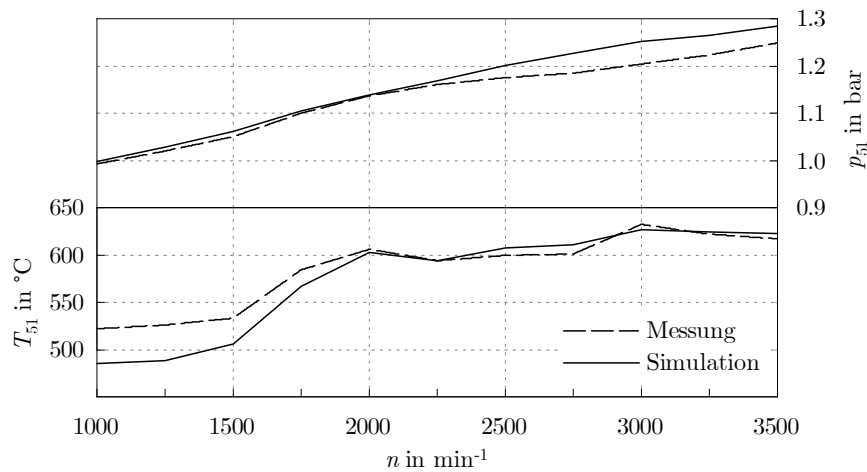
Abbildung 7.9: Gaszustand im Abgasnachbehandlungssystem
