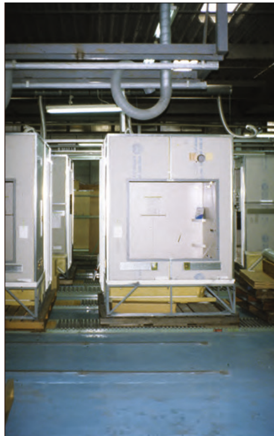
Abb. 44: Fließfertigung von Sanitärraumzellen als Subsysteme für vorgefertigte Gebäude in Raumzellenbauweise | Inax, Nagoya, Japan
