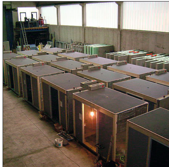
Abb. 43: Vorgefertigte Sanitärraumzellen werden in Österreich von der Firma Insta-Bloc in Stahl-Leichtbauweise (hier abgebildet), Leichtbetonbauweise oder in GFK-Sandwichbauweise gefertigt.
