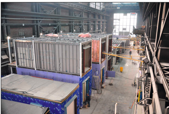
Abb. 39: Raumzellen in Stahlbetonbauweise oder in Stahl-Leichtbauweise (hier abgebildet) werden in den USA nur von wenigen Herstellern fabriziert.
