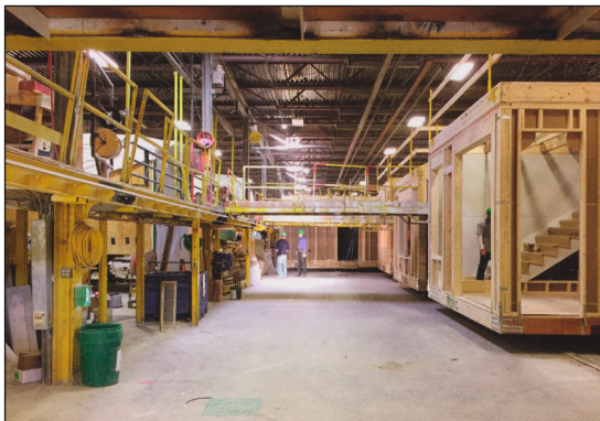
Abb. 38: Die Fertigung von Raumzellen in den USA erfolgt heute zumeist in Holzrahmenbauweise.
