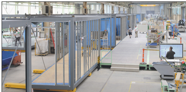
Abb. 52: a Gebäude aus umfunktionierten Fracht-Containern | Platoon Kunsthalle, Seoul | Platoon & Graft Architects b, c Temporäres Bürogebäude und Baustellenbüro aus Bau-Containern | Fa. PROCONTAIN, D d, e Fertigung und Montage von Raumzellen in Stahl-Leichtbauweise (modular frame system) | Fa. ALHO, D
