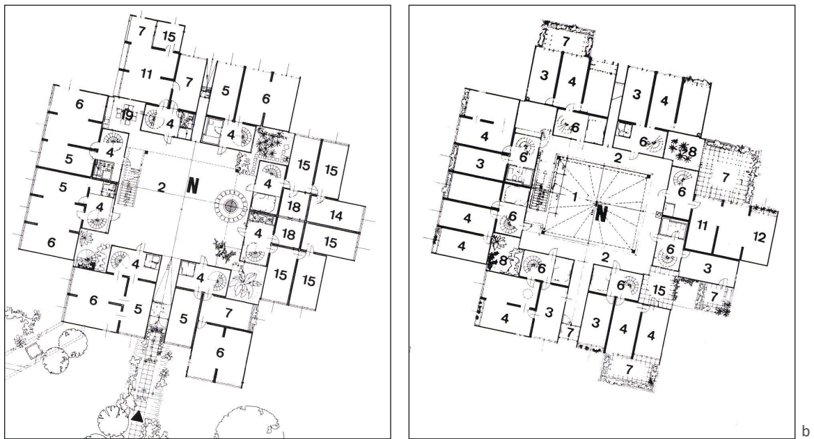
Abb. 66: a Erdgeschoß-Grundriss eines Atriumhauses der Anlage Les Palétuviers III b Obergeschoß-Grundriss eines Atriumhauses der Anlage Les Palétuviers III
