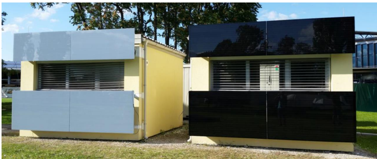
Abbildung 3-4: Foto des gekühlten/beheizten Raumes (rechts), des Referenzraumes (links) und des Versorgungscontainers (hinter den beiden Räumen erkennbar) (Mach & Heinz, 2017)
