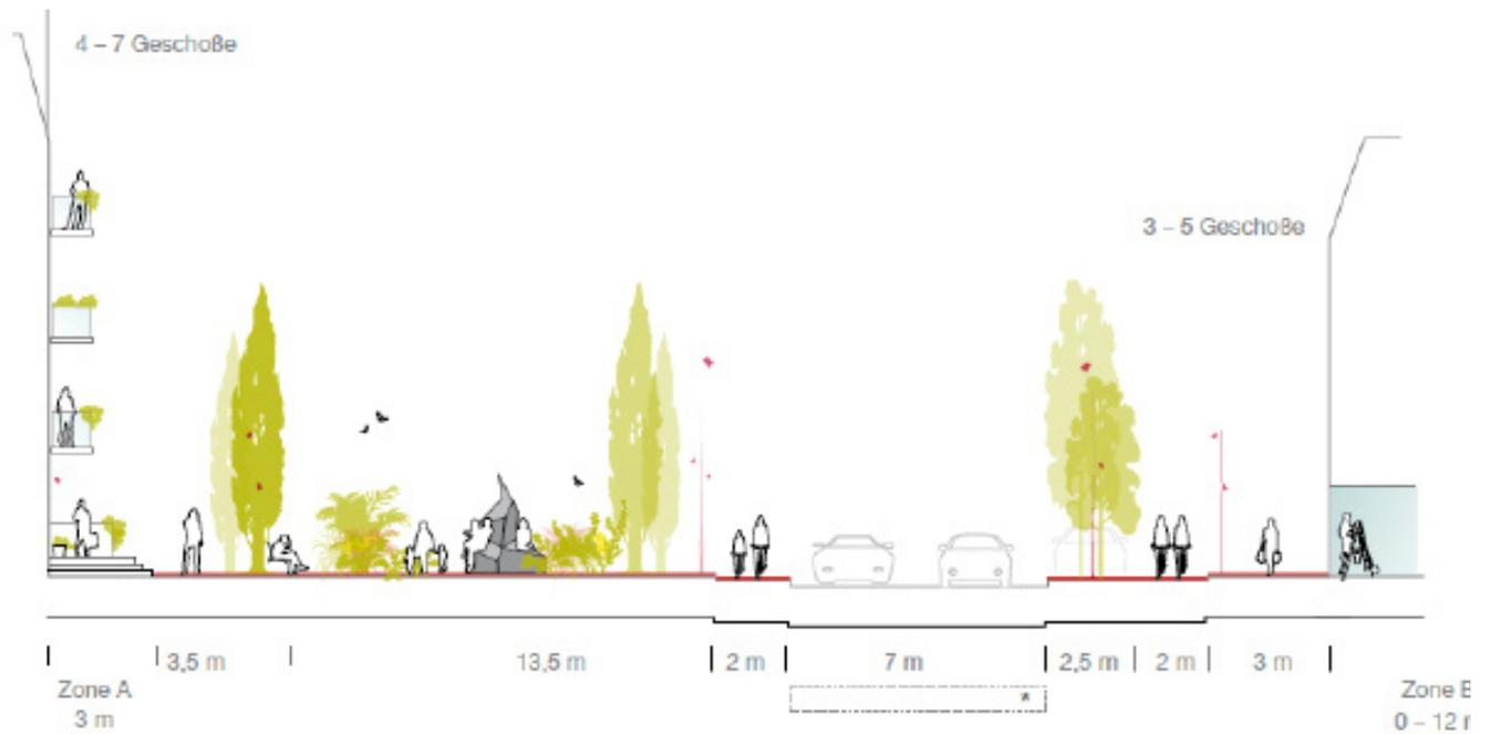
Abb.18 Gehl Architects, Ringstrasse, 2009, Prinzipschnitt C-C
