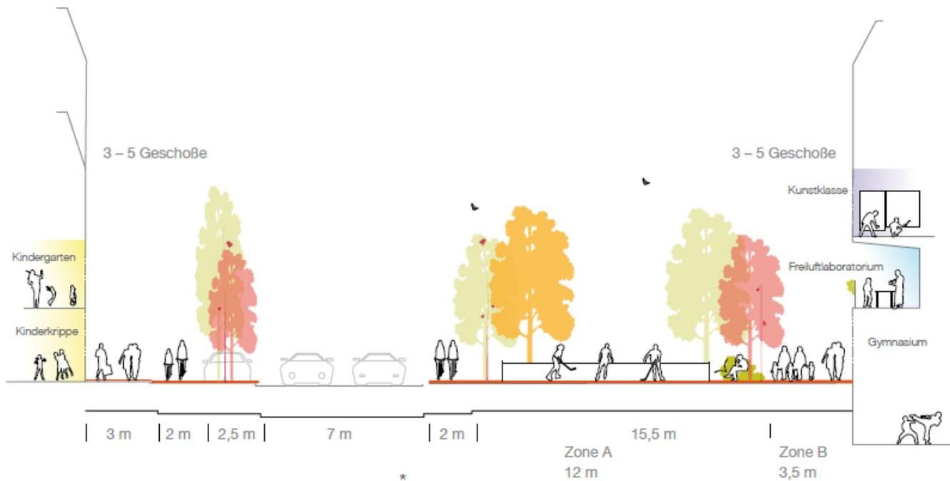
Abb.21 Gehl Architects, Ringstrasse, 2009, Prinzipschnitt F-F
