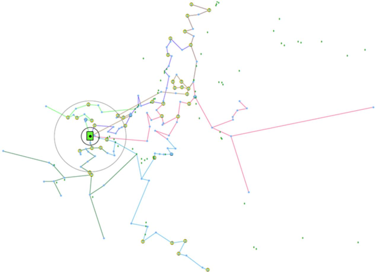
Abbildung 76 Greenfield-Planning des UMspannwerk-Netzes EZ
