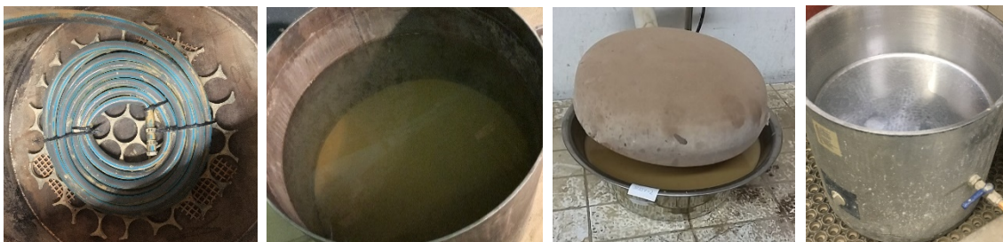
Abb. 61: Von links nach rechts: Schlauchspirale, Auffangbehälter, Verdampfungslampe, Ultraschallbecken;
