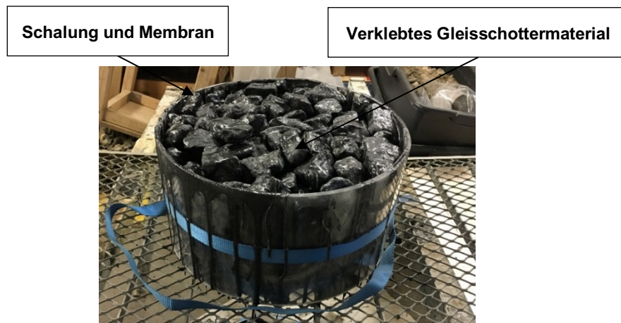
Abb. 51: Herstellung einer GSP
