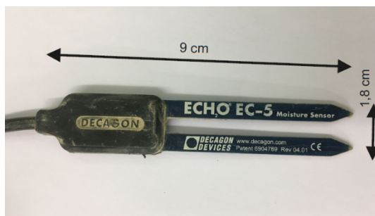
Abb. 53: EC-5 TDR-Sensor von UMS
