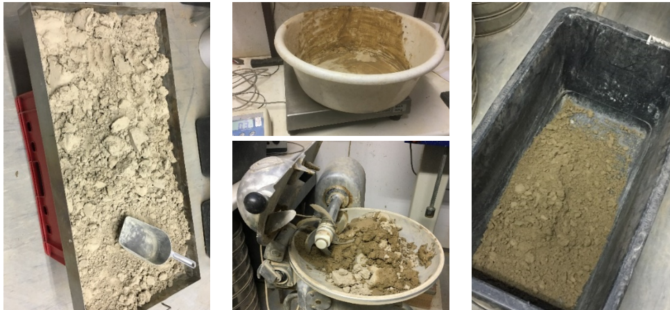
Abb. 58: Links: Gebrochenes Trockenmaterial, Mitte oben: Einwaage, Mitte unten: Flügelmischer mit Material, Rechts: Abgemischtes Material;
