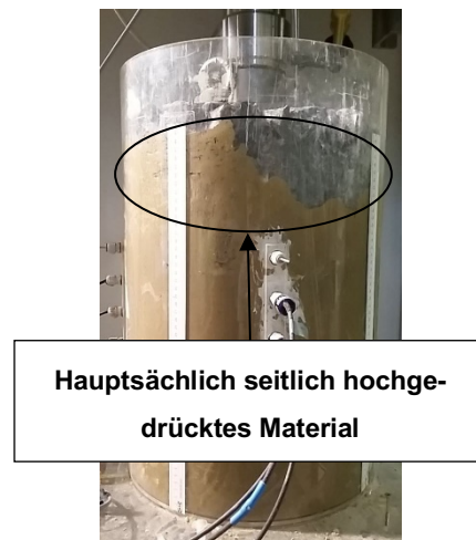
Abb. 67: Versuchszylinder nach Versuchsende V_V1 ges
