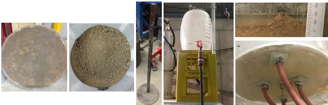
Abb. 59: Von links nach rechts: gesinterte Bronzeplatte, Einbau einer Bodenschicht, Stampfer, Wasserkanister, Sättigungsschläuche, Wasserstand nach der Sättigung;
