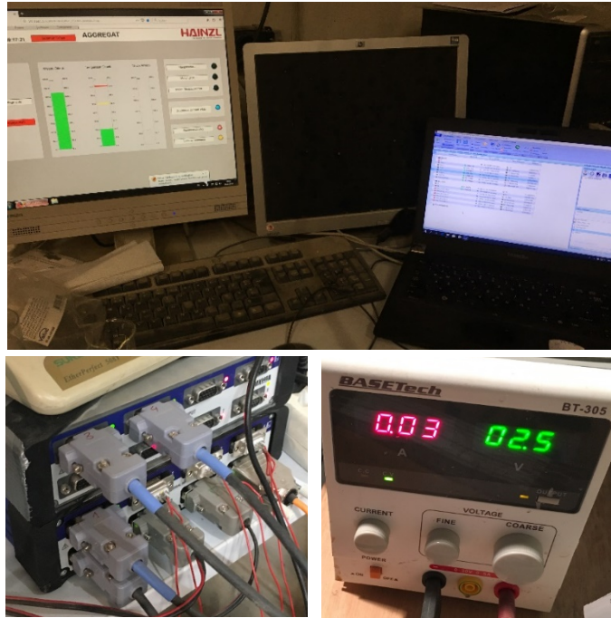
Abb. 52: Oben: Bildschirm links für die Prüfstandkontrolle, Bildschirm rechts zur Auswertung der Messdaten (CATMAN Software), Links unten: Datenlogger, Rechts unten: Externes Stromgerät für die TDR-Sonden;
