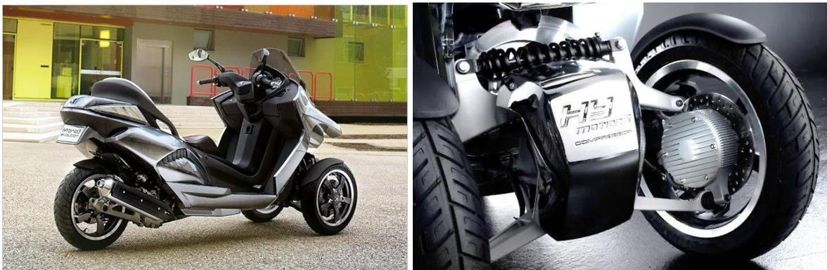
Abbildung 18 : Peugeot Hybrid 3 Evolution Concept Dreirad mit Elektromotoren in den Radnaben der Vorderräder und konventionellen Antrieb des Hinterrades [45]
