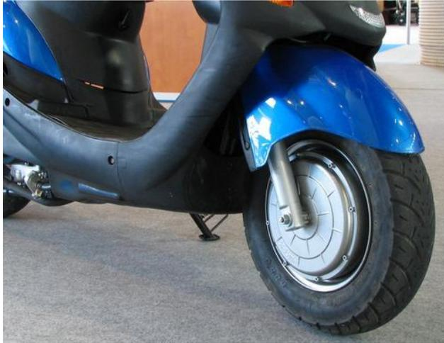
Abbildung 17: „Axel-Split“ Variante mit Elektromotor im Vorderrad [44]
