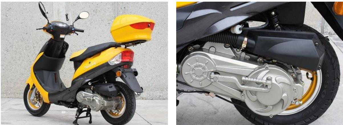
Abbildung 16 : Asiatische „Parallel-Hybrid“ Variante mit in der Triebwerkschwingen integrierten Elektromotor [43]
