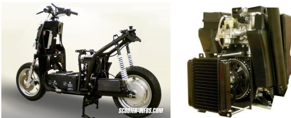
Abbildung 19 :Malaguti HEM-links und Range Extender Einheit -rechts [46]
