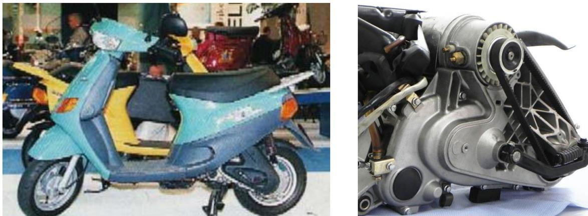
Abbildung 12 : ZIP 50 Bimodale [36] und Hybrid-Triebsatzschwinge [37]
