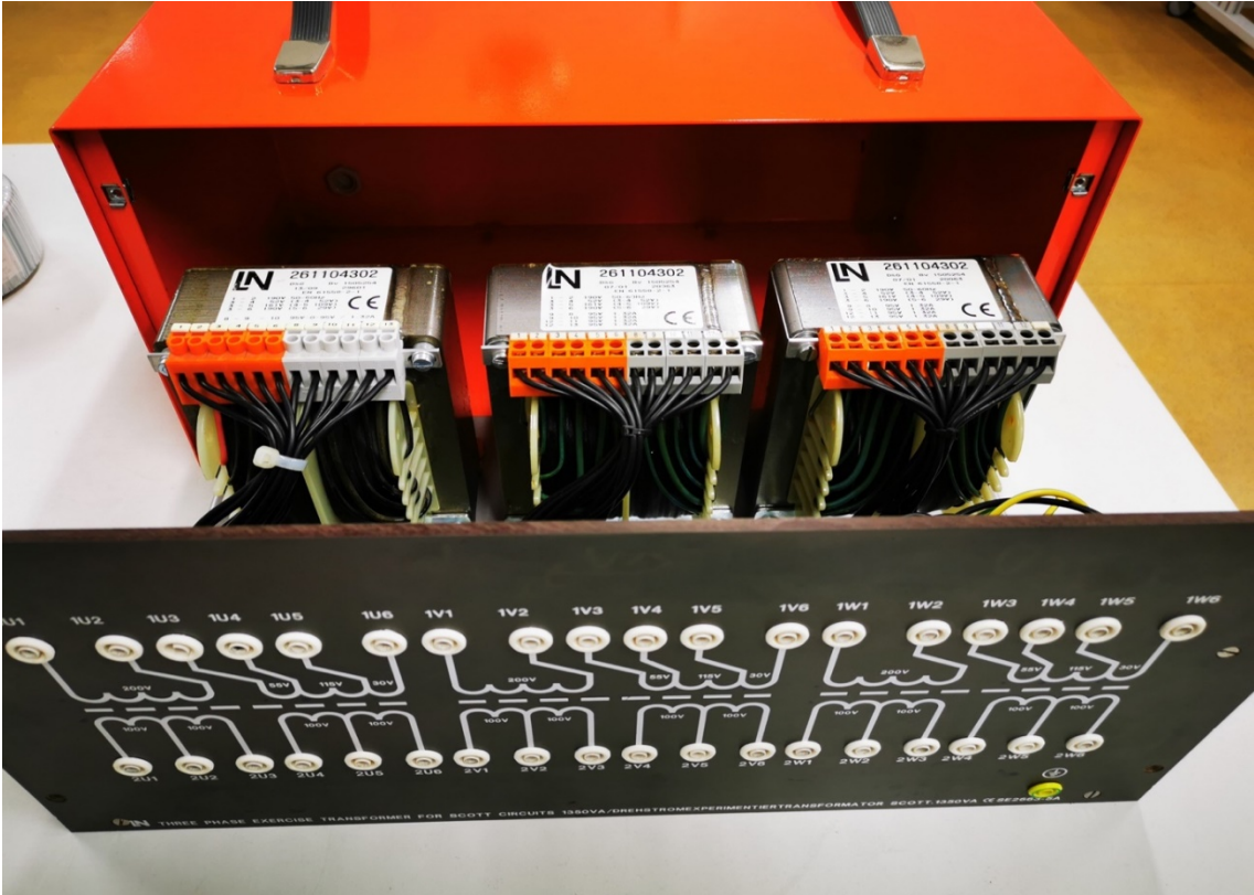
Abbildung 8: Dreiphasiger Transformator Nummer 3 mit Ansicht auf den Innenaufbau I.
