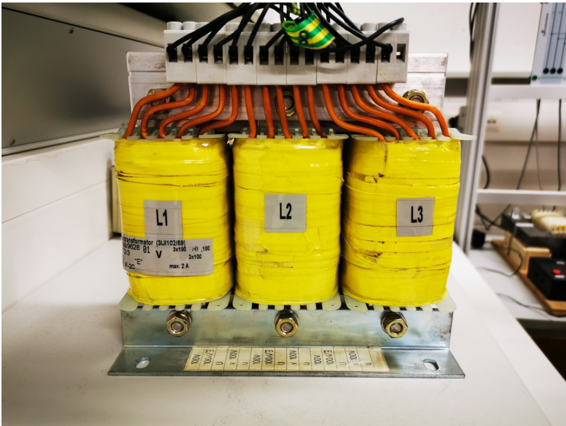
Abbildung 10: Dreiphasiger Transformator Nummer 4 in der Dreischenkelausführung.
