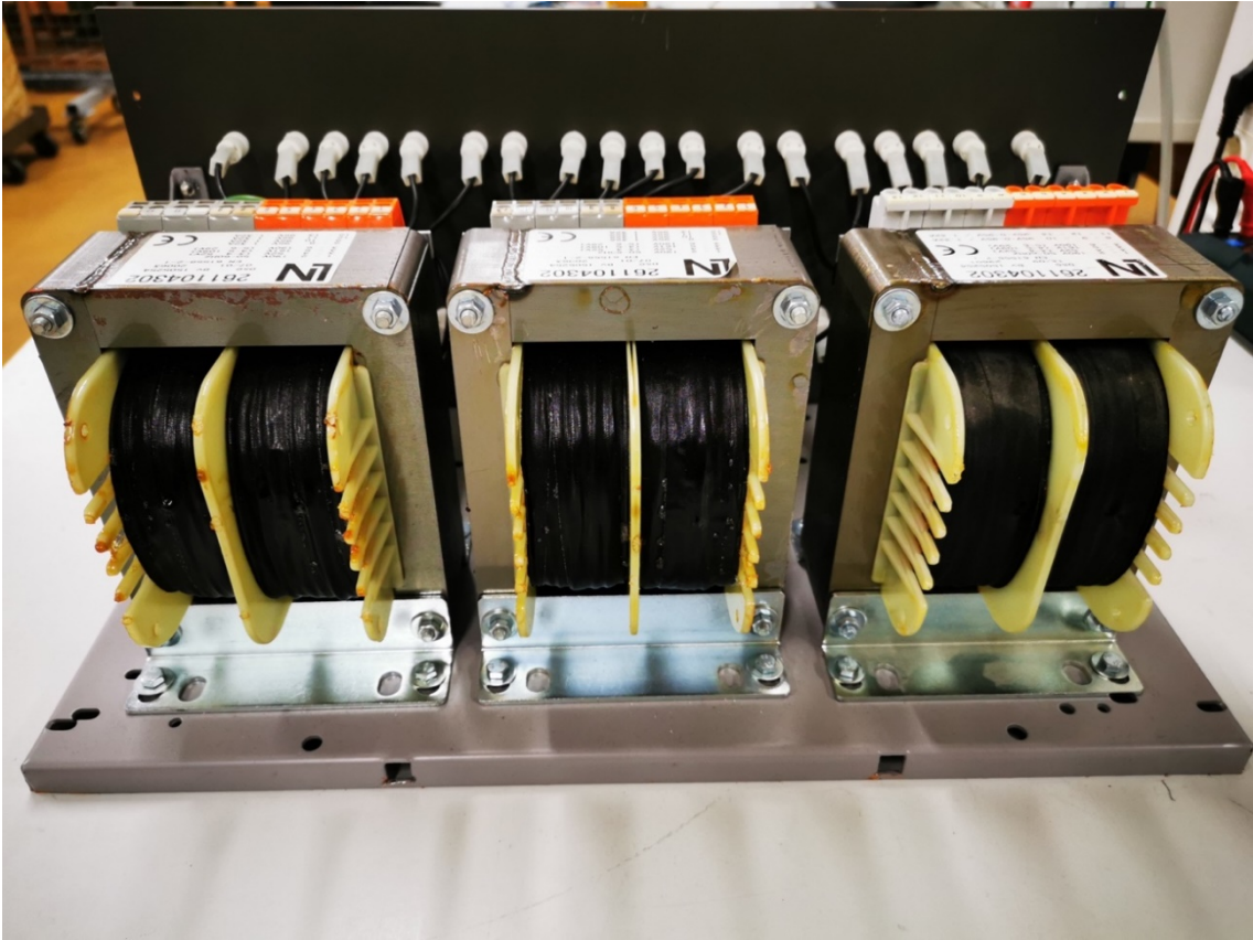
Abbildung 9: Dreiphasiger Transformator Nummer 3 mit Ansicht auf den Innenaufbau II.
