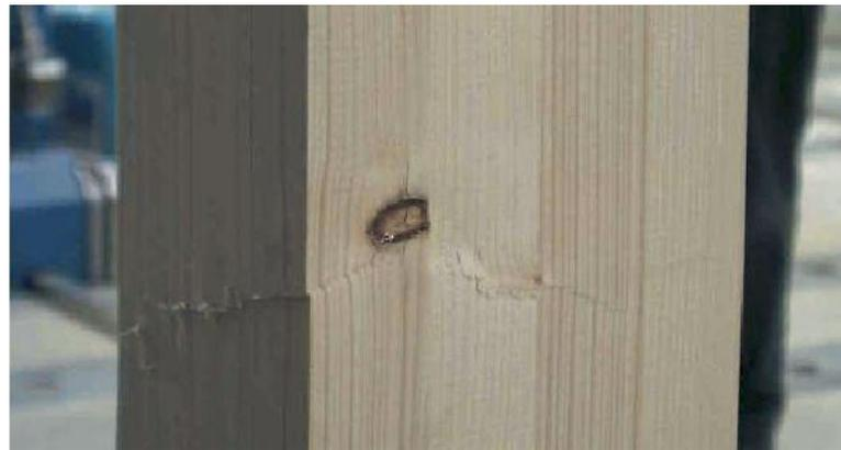
Abbildung 2-2: *Ausbildung einer Scherebene beginnend bei Ast, adaptiert aus [12]*
