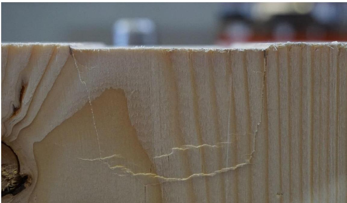
**Abbildung 4-3:** *Darstellung des versagten Bereichs im Detail*
