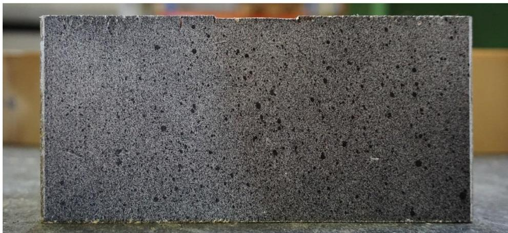
**Abbildung 3-5: Kontrastfläche eines Prüfkörpers als Vorbereitung für Messungen mit dem System Mercury**
