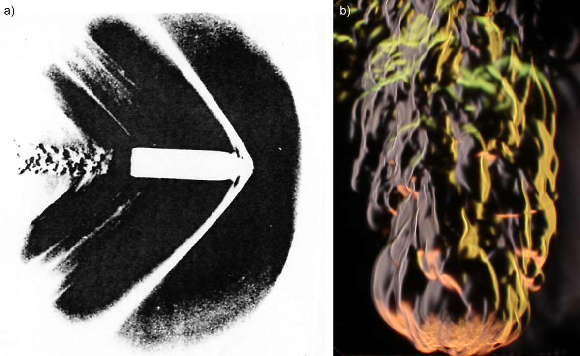
Abbildung 6: a) Eine der ersten Aufnahmen der Schockwellen eines Pistolenprojektils mittels Schlierenfotografie (Mach & Salcher, 1887). b) Farbschlieren Aufnahme eines auch in dieser Arbeit untersuchten Brenners (Salcher, 2014). Die vier Farben Rot, Gelb, Grün und Blau geben die Richtungen der jeweiligen Dichtegradienten an (Rot entspricht einer Dichtezunahme nach unten, Grün nach oben, Gelb nach rechts, Blau nach links).
