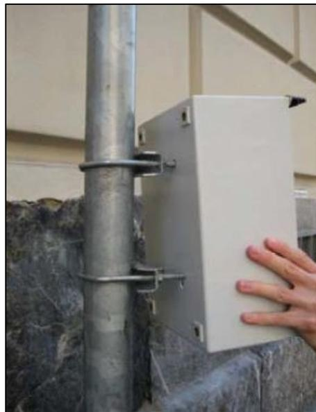
**Abbildung 15 Montage des Seitenmessradars (Vergleichsmessung Seitenradar – Videodetektion, Projektarbeit Verkehr, 2009)**
