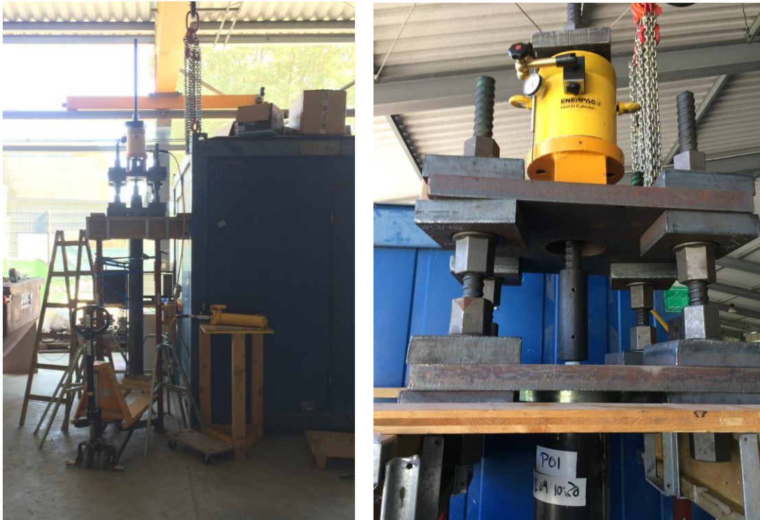
Abb. 22: Aufbau Ausziehversuche erste Versuchsreihe
