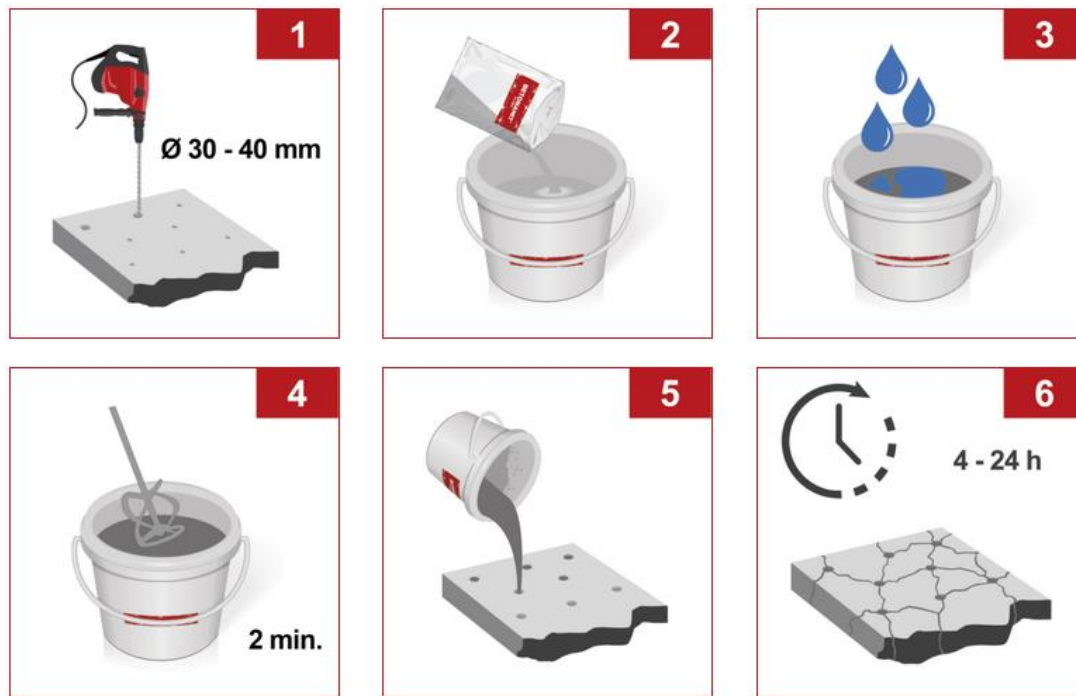
Abb. 17: Arbeitsablauf Quellsprengstoff (Betonamit®, KUBATEC BMT AG, 2019)
