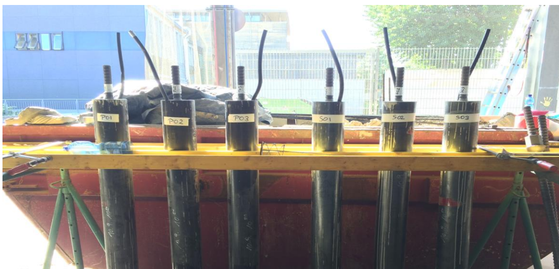
Abb. 21: Versuchskörper vor Einfüllen des Quellsprengstoffes
