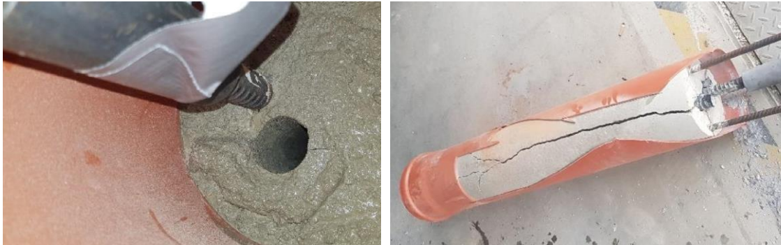
Abb. 18: Vorversuche Quellsprengstoff; links: simuliertes Bohrloch, rechts: zerstörter Verpresskörper
