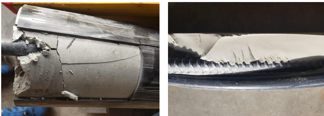
Abb. 6: Versuchsergebnisse; Links: Aufgesprengter Versuchskörper im Kopfbereich; Rechts: Detailansicht aufgesprengter Verpresskörper
