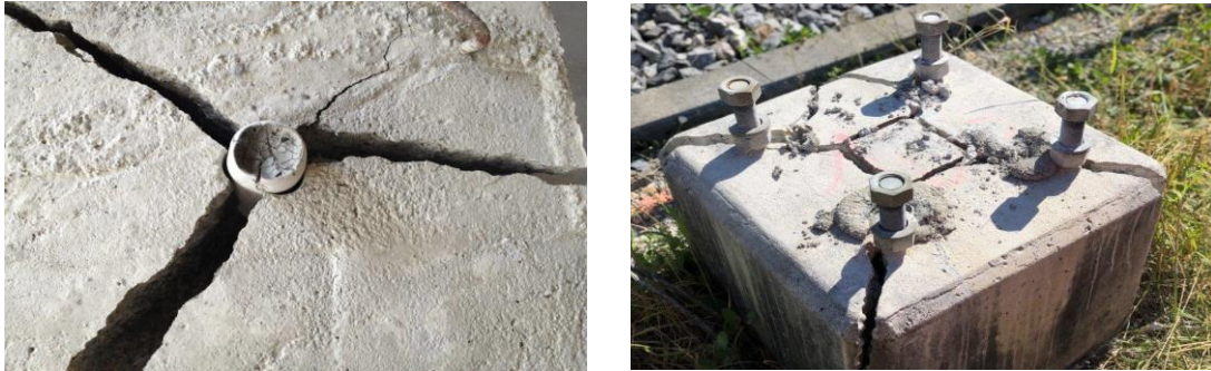
Abb. 16: Wirkungsweise Quellsprengstoff (Betonamit®, KUBATEC BMT AG, 2019)
