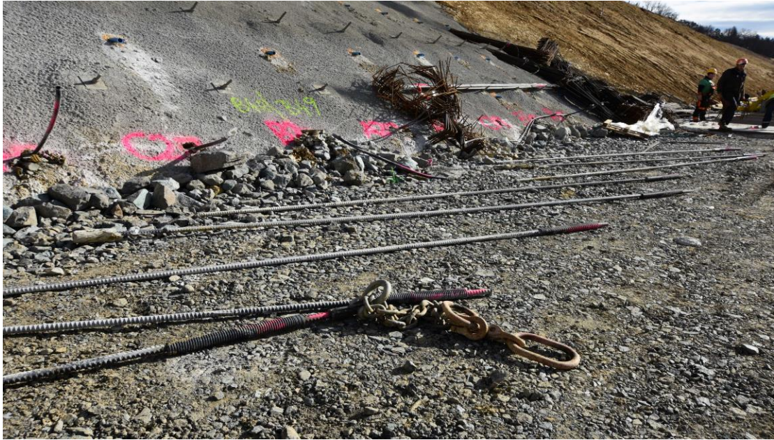
Abb. 39: Ausgezogene Stabanker (21 Tage Festigkeit)
