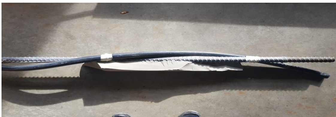
Abb. 29: freigelegter Verbundkörper (zweite Versuchsreihe)
