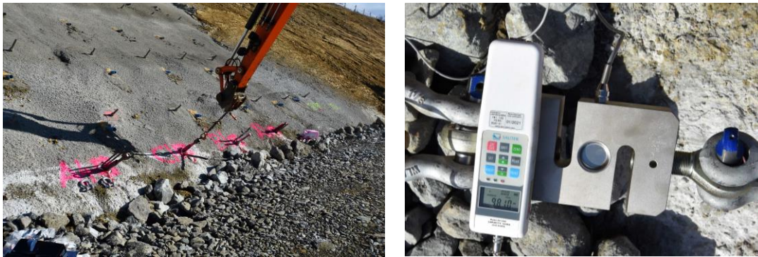
Abb. 35: links: erster Ausziehversuch, rechts: Maximalwert erster Ausziehversuch
