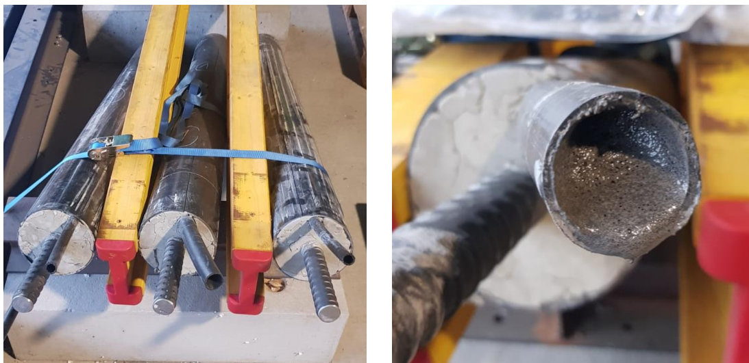
Abb. 5: Versuchskörper; Links: Versuchskörper vorbereitet; Rechts: Eingebrachter Quellsprengstoff im Sprengschlauch
