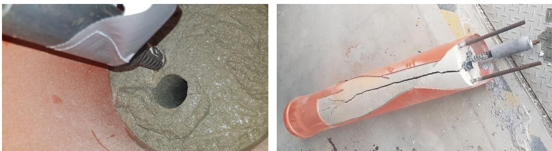
Abb. 4: Vorversuche Quellsprengstoff; Links: Im Zuge der Verfüllung hergestelltes Einfüllloch in einem Verpresskörper; Rechts: Zerstörter Verpresskörper
