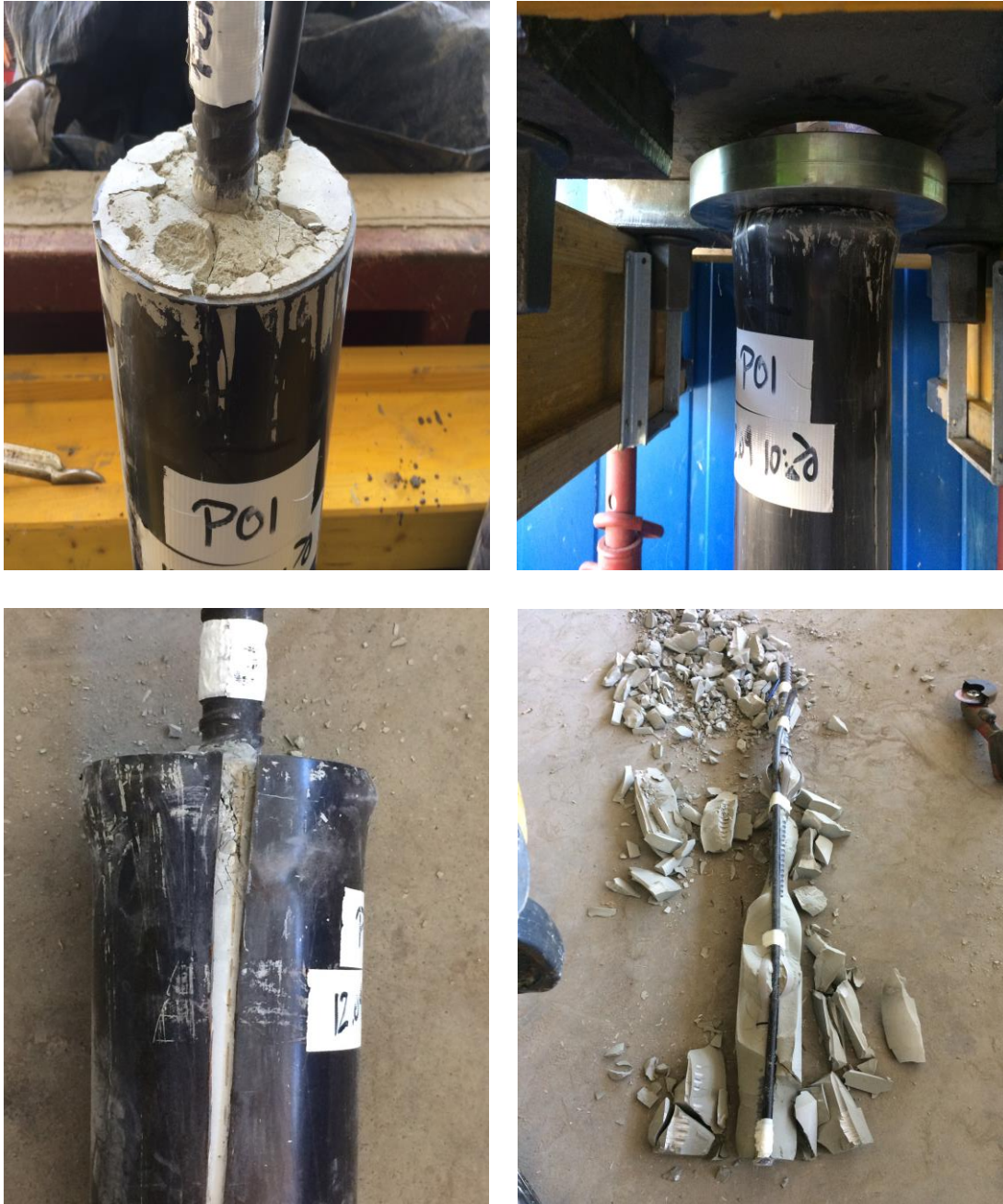
Abb. 23: Versuchskörper o.l.: nach abgeklungener Reaktion des Quellsprengstoffes, o.r.: während Ausziehversuch, u.l.: nach Ausziehversuch, u.r.: freigelegter, gesprengter Versuchskörper
