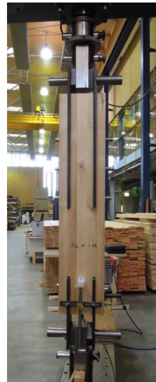
Abbildung 3-7: Darstellung der Prüfketten der Serien B1 ÷ B3 (links) und B4 ÷ B5 (Mitte); eingebauter Prüfkörper der Serie B4.1 (rechts)
