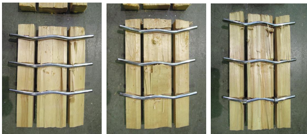
Abbildung 4-30: Detailaufnahmen der versagten Verbindungen der Prüfkörper B6.1-05 (links), B6.2-04 (Mitte) und B6.3-06 (rechts)
