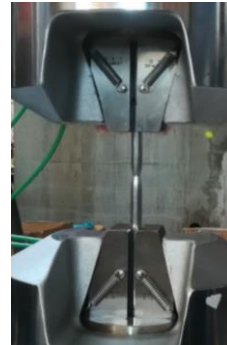
Abbildung 3-9: Zugversuch der Stabdübel
