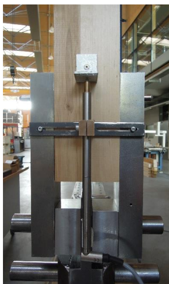
Abbildung 3-5: Anschlussvariante mit Stahlblechen
