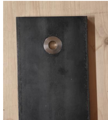
Abbildung 3-6: Einsatz von Verschleißstücken
