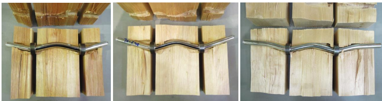
Abbildung 4-25: Detailaufnahmen der Prüfkörper B4.1-10 (links), B4.2-02 (Mitte) und B4.4-05 (rechts)
