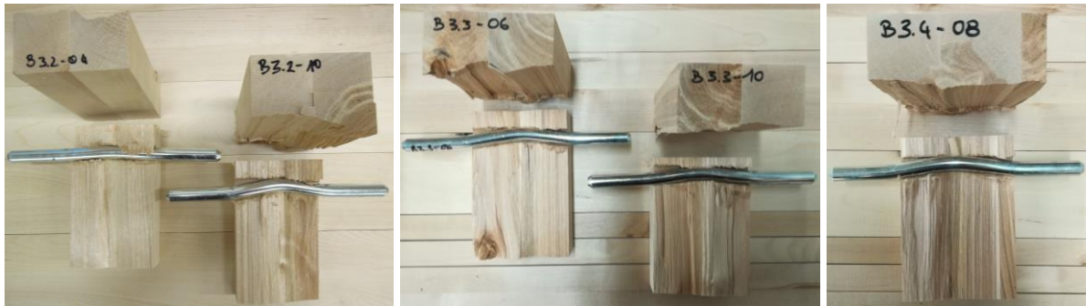
Abbildung 4-22: Detailaufnahmen geprüfter Verbindungen aus der Hauptserie B3
