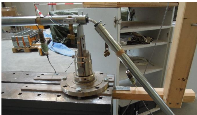
Abbildung 3-10: Biegeversuchsaufbau der Stabdübel
