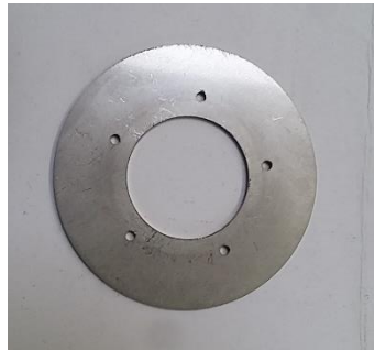
Abb. 2-6 Neu entwickelte Geometrie der Rotorscheiben für das Handling von Gasströmen
