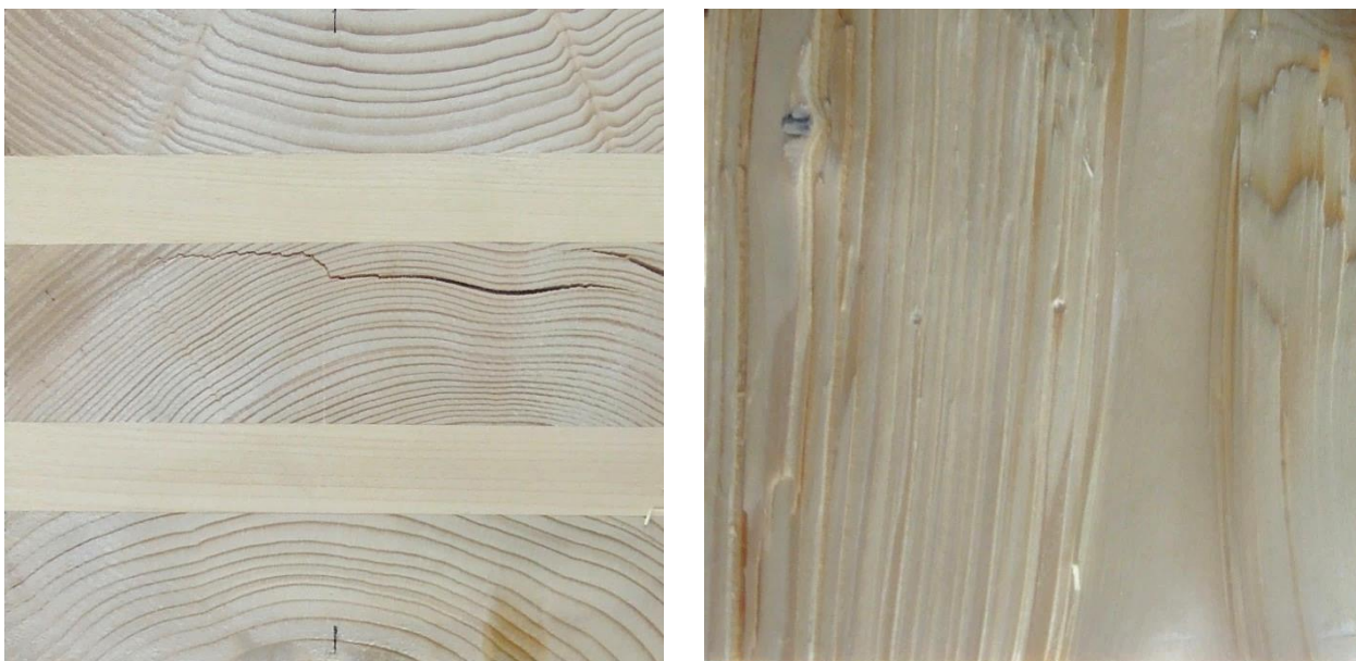
Abbildung 2-42 Mischbruch Prüfkörper (MBP) bei Prüfkörper 7-11 (links: Bruchansicht ; rechts: Bruchfläche )
