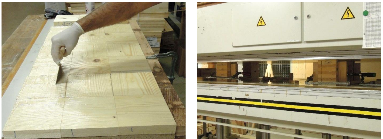
Abbildung 2-23 Verklebung der Prüfkörper (links: Klebstoffauftrag; rechts: Pressen)
