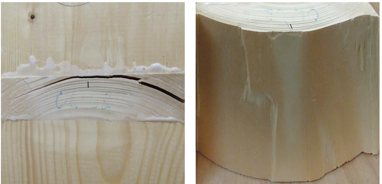
Abbildung 2-40 Jahrringbruch (JB) bei Prüfkörper 1-08 (links: Bruchansicht; rechts: Bruchfläche)
