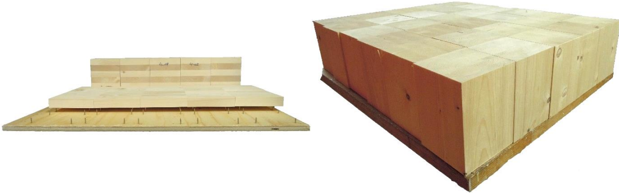
Abbildung 2-24 Montage Lasteinleitungsblock 150^2 \text{ mm}^2 (links: Prüfkörper auf Nagelbrett; rechts: Lasteinleitungsblöcke vor Klebstoffauftrag)
