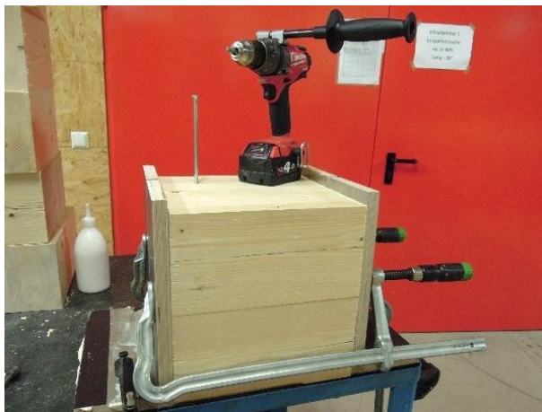
Abbildung 2-25 Montage Lasteinleitungsblock 300^2 \text{ mm}^2 (links: Blockverleimung; rechts: Pressen mit Auflast)
