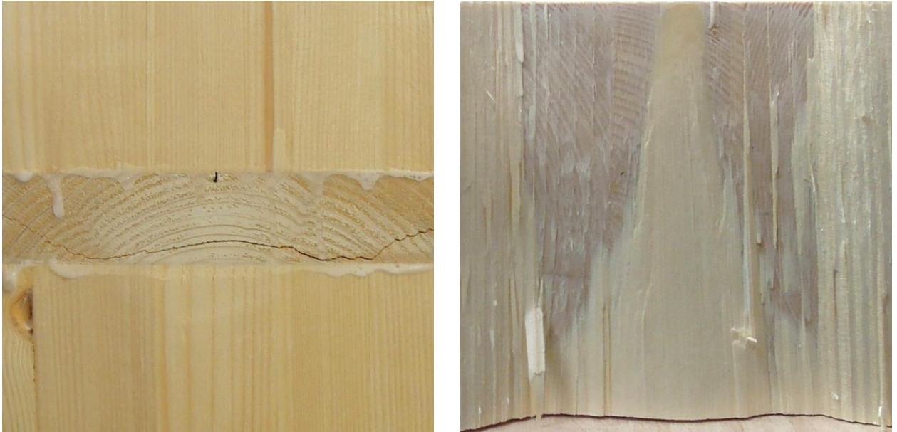
Abbildung 2-39 W-Bruch (WB) bei Prüfkörper 1-03 (links: Bruchansicht; rechts: Bruchfläche)
