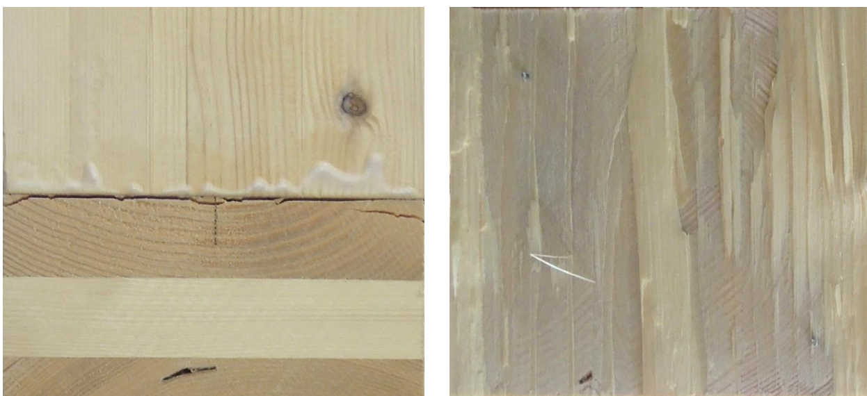
Abbildung 2-38 Mischbruch im Lastenteilbereich (MBL) bei Prüfkörper 4-18 (links: Bruchansicht; rechts Bruchfläche)
