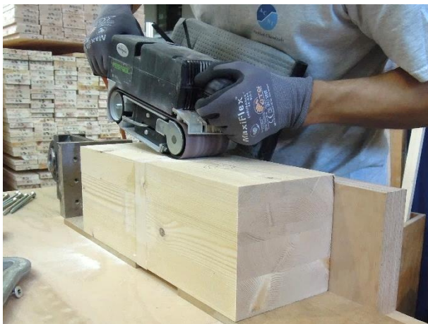
Abbildung 2-28 Präparation der Prüfkörper (links: Abschleifen von Klebstoffresten; rechts: Montage der Lasteinleitungsplatten)
