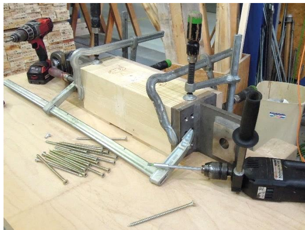
Abbildung 2-28 Präparation der Prüfkörper (links: Abschleifen von Klebstoffresten; rechts: Montage der Lasteinleitungsplatten)
