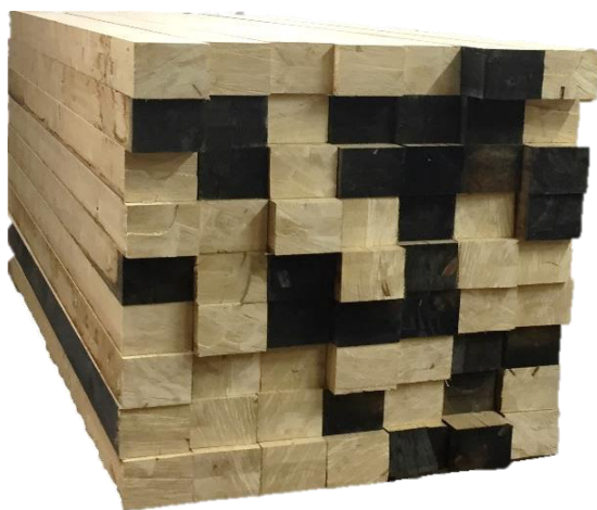
Abbildung 2-19 Holz zur Herstellung der Lasteinleitungsblöcke (links: 150^2 \text{ mm}^2 ; rechts: 150 \times 300 \text{ mm} )
