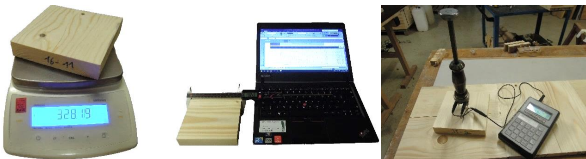
Abbildung 2-21 Aufnahme der Materialparameter (links: Masse; mittig: Geometrie; rechts: Holzfeuchtigkeit)
