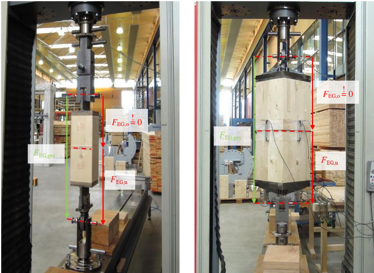
Abbildung 2-34 Eigengewichtskorrektur (links: Serien mit Querschnitt 150^2 \text{ mm}^2 ; rechts Serie mit Querschnitt 300^2 \text{ mm}^2 )
