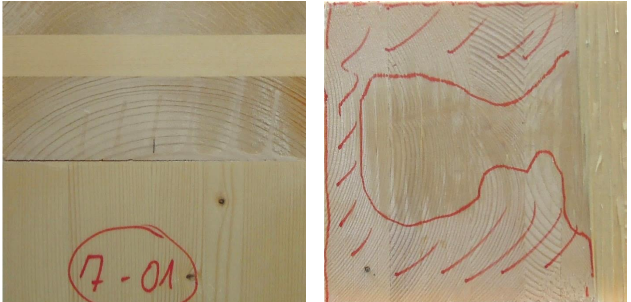
Abbildung 2-43 Klebstoffversagen im Lasteinleitungsbereich (KV) bei Prüfkörper 7-01 (links: Bruchansicht; rechts: Bruchfläche)
