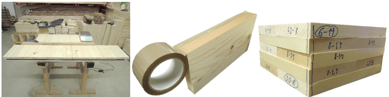
Abbildung 2-22 „Assembling“ der Rohlinge (links: Aufnahme der Oberfläche; mittig: Schmalseitenabklebung; rechts: Zusammensetzen)
