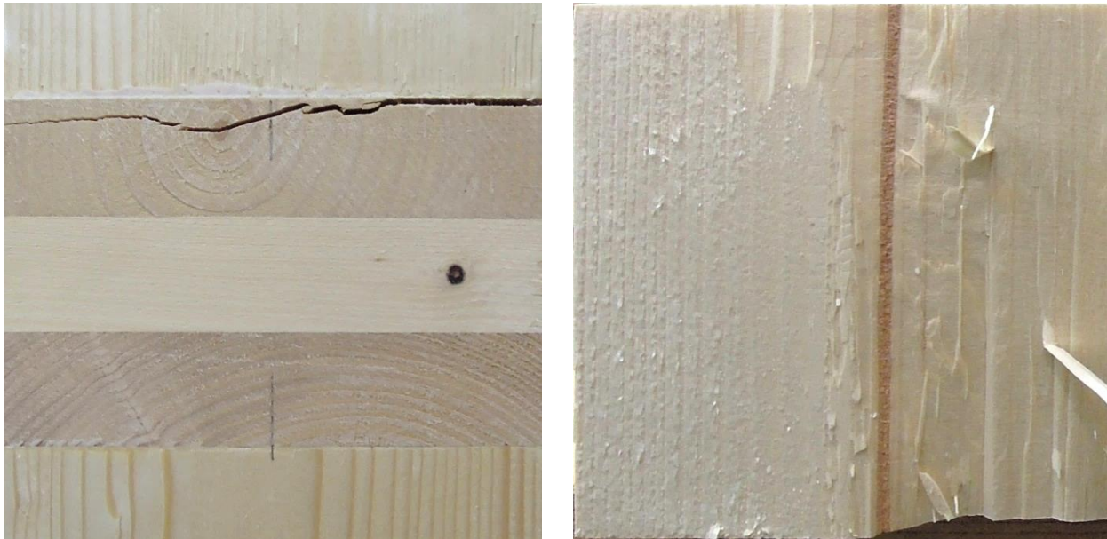
Abbildung 2-41 Markröhrenbruch bei Prüfkörper 3-19 (links: Bruchansicht ; rechts: Bruchfläche )
