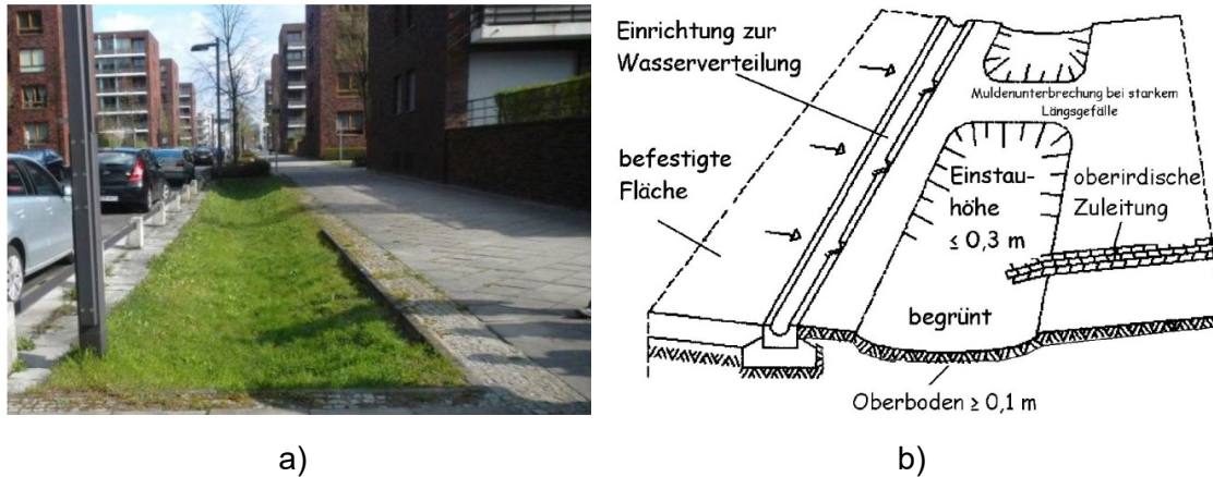
Abbildung 4-4: a) Beispiel einer Muldenversickerung (Matzinger et al., 2017), b) Aufbau einer Muldenversickerung (DWA, 2005)
