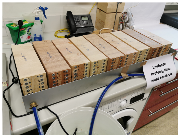
Abbildung 7-7: Versuchsaufbau zur Bestimmung der Quellung und des Wasseraufnahmekoeffizienten.
