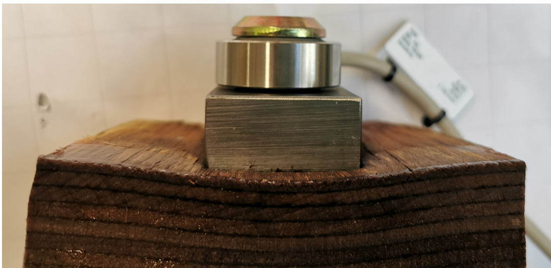
Abbildung 8-30: Plastische Verformungen rund um das Stahlblech durch die behinderte Quellung
