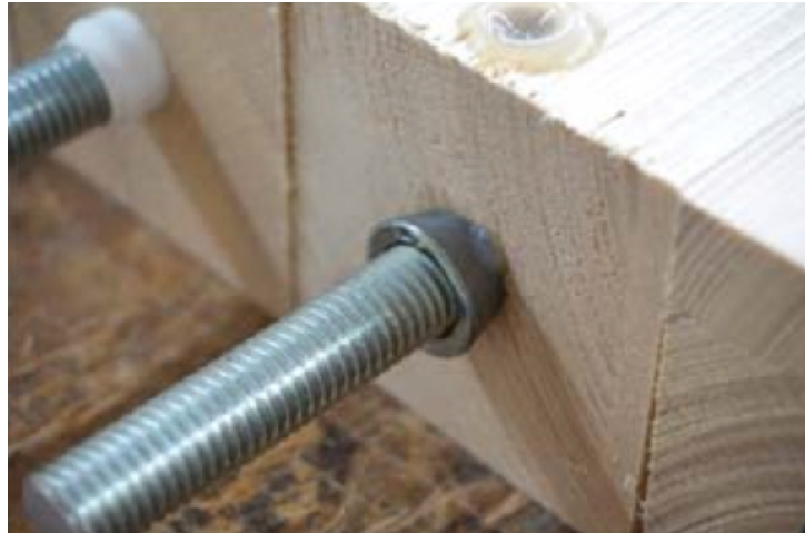
Abbildung 4-8: In Hirnholz eingeklebte Gewindestange [30]
