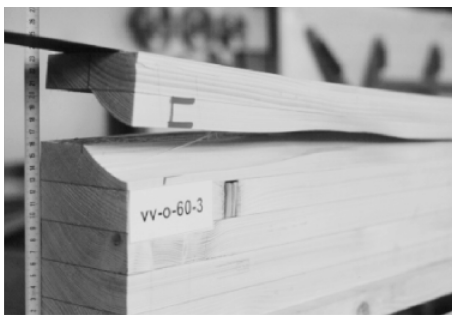
(a) Querkzugversagen des Holzes
