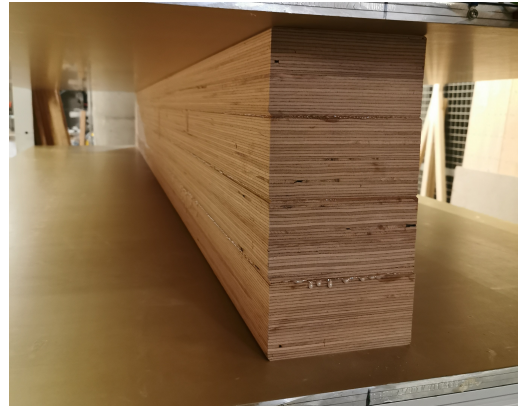
(b) übereinanderliegend verklebte Einzelträger in der Presse
