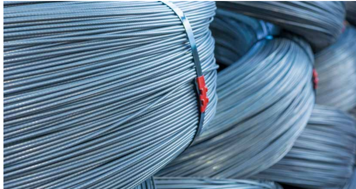
Abbildung 4-6: profilierter Spanndraht zu Coils aufgewickelt [36]
