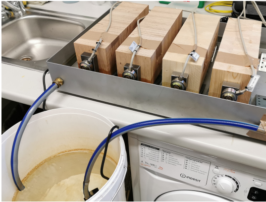
(a) Prüfkörper in Wasserlagerung
