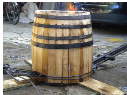
(b) Zusammenziehen des Fasses mit dem Fasszug
