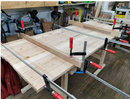
(a) Schmalseitenverklebung zu Platten
