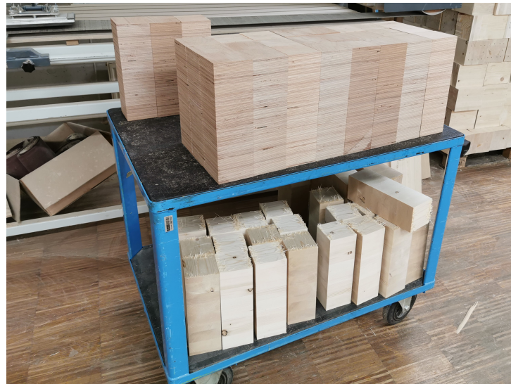
Abbildung 7-4: fertig zugeschnittene Probekörper
