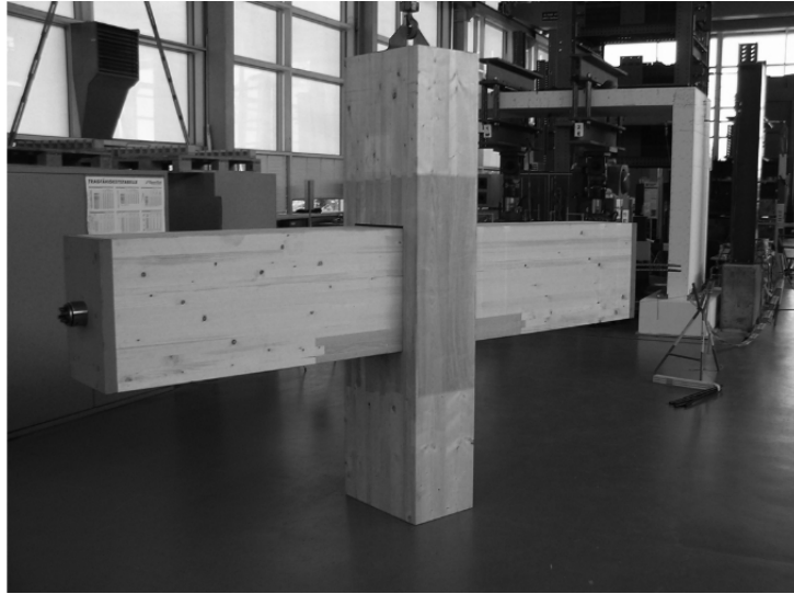
Abbildung 3-8: Rahmendetail aus BSH der ETH Zürich. Die dunklen Bereiche kennzeichnen die Verstärkung mit Hartholz [16]
