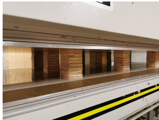
(b) Prüfkörperrohlinge in der Presse
