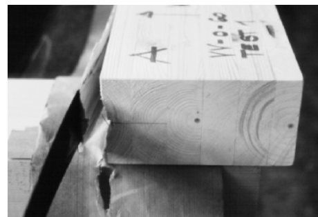
(b) Schubversagen in der Verbundfuge
