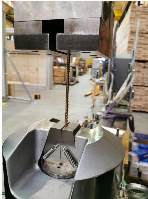
Abbildung 7-11: Prüfaufbau für die Schraubenzugprüfung
