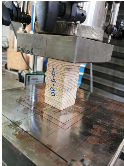
Abbildung 7-9: Bestimmung der Querdruckfestigkeit und des Elastizitätsmoduls quer zur Faser- Versuchsanordnung
