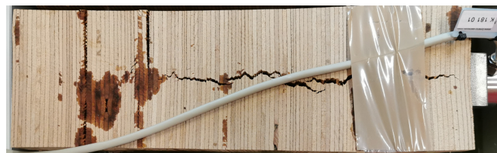
Abbildung 8-33: Aufspalten des Probekörpers entlang der Schraubenachse zufolge Querzug
