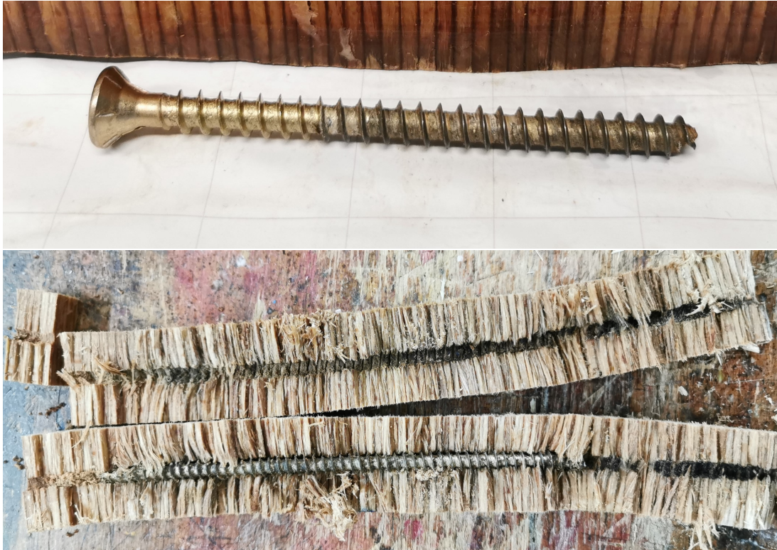
Abbildung 8-29: Schraubenbruch im Prüfkörper BF-VG-NV-300-1600-01. Oben: Schraubenkopf, unten: Schraubenkanal mit restlicher Schraube
