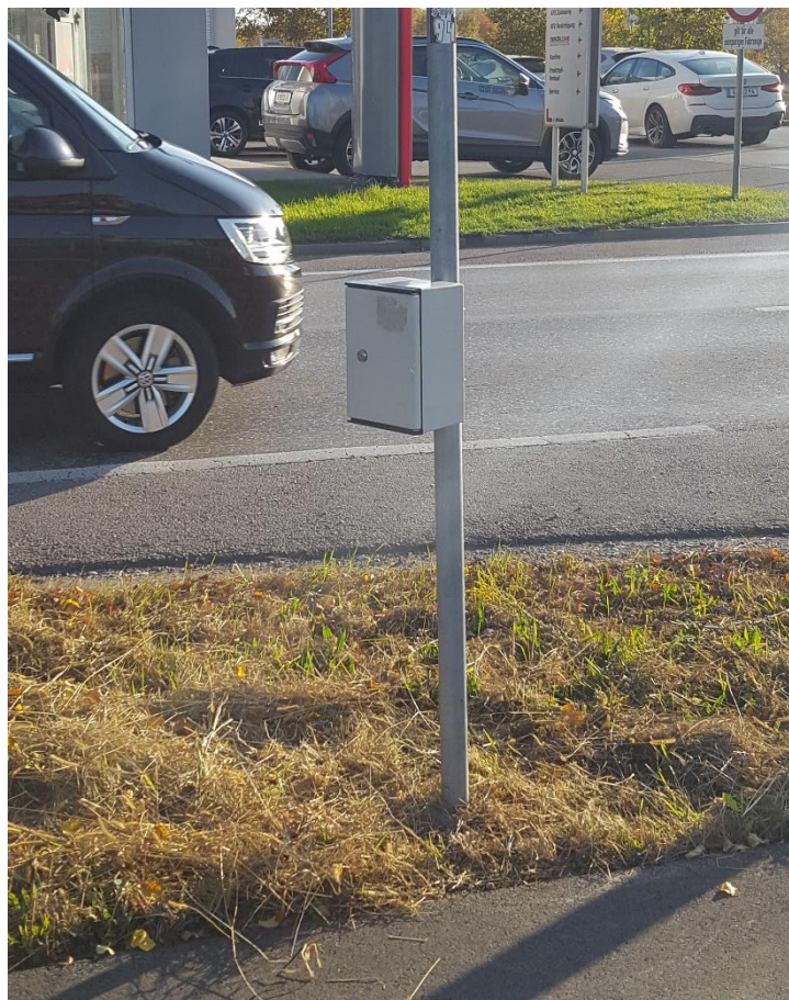
Abbildung 42: Zählgerät Sierzega SR4 Wetzelsdorfer Straße
