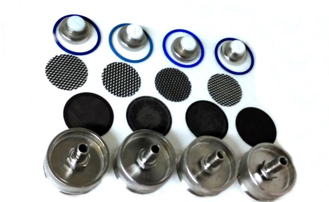
Abbildung 4-7: Vier Paare Unterbau-Schraubverschlüsse zur Aufnahme der Lochbleche, der Siebe, der Filter (nicht dargestellt) und der Dichtringe sowie die vier Zylinderverschlüsse zum Verschließen der Druckfiltrationsgeräte (von unten nach oben aufgelistet)
