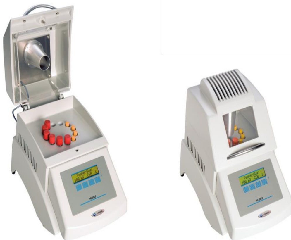
Abbildung 4-9: Verwendeter Heizblock zum chemischen Aufschließen der CSB-Küvetten mit geöffnetem und geschlossenem Deckel (Produktflyer der Fa. HACH))
