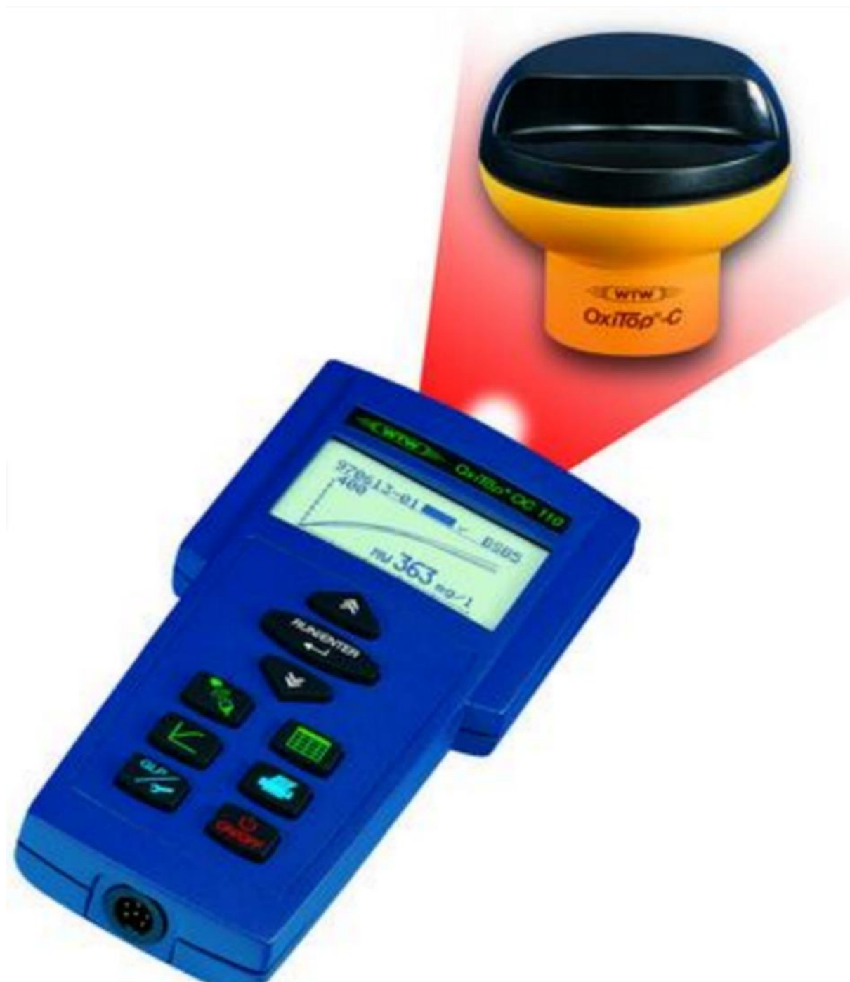
Abbildung 4-4: Ausrichtung des Controllers zum Messkopf während des Datentransfers
