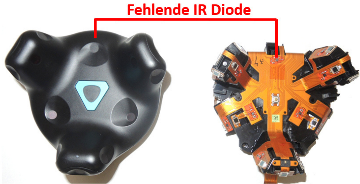
Abbildung 3.4: Tracker Vergleich original und mit geöffnetem Gehäuse [Bauer, Jost und Lienhart, 2020]
