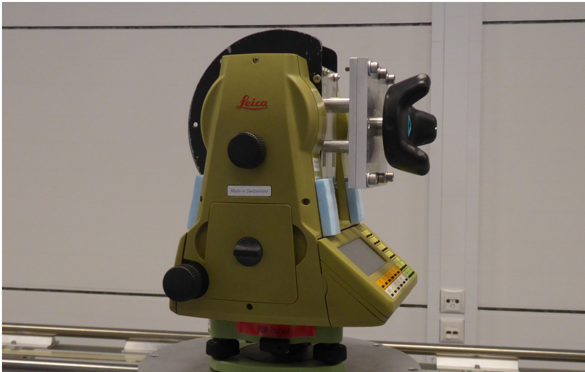
Abbildung 4.46: Messaufbau Kontrolle des Koordinatenzentrums des Trackers
