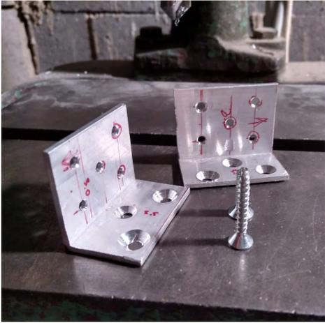
Abb.178. Winkelbeschläge aus Aluminiumprofilen
