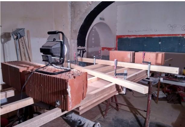
Abb.167. Verleimung des Blattes aus MDF-Platten
