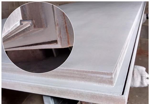
Abb.169. Prototyp 1: Nut für Dichtung im Blatt eingefräst
