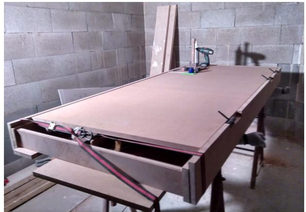
Abb.170. Prototyp 1: Montage der Zarge mit Blatt im rechten Winkel
