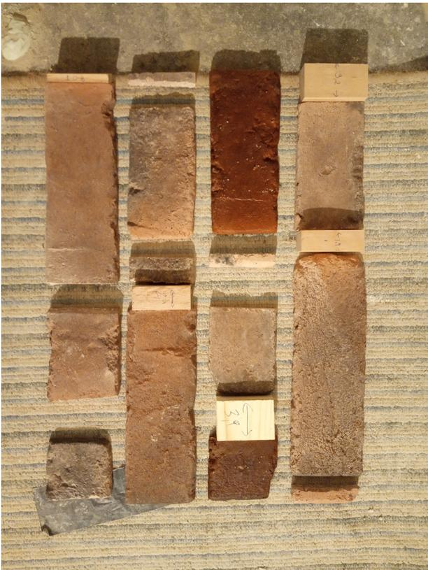
Abb.233. Schnittflächen als ausgelegtes Muster aus Ziegelstücken
