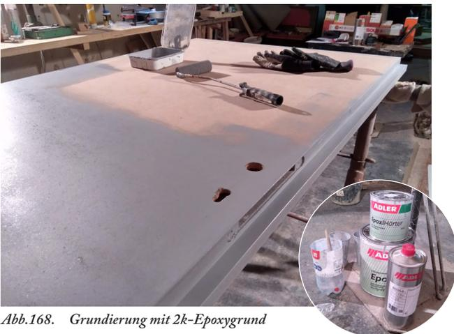
Abb.168. Grundierung mit 2k-Epoxygrund
