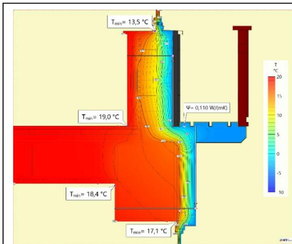
Abbildung 165: Temperaturverteilung Balkonanschluss saniert
