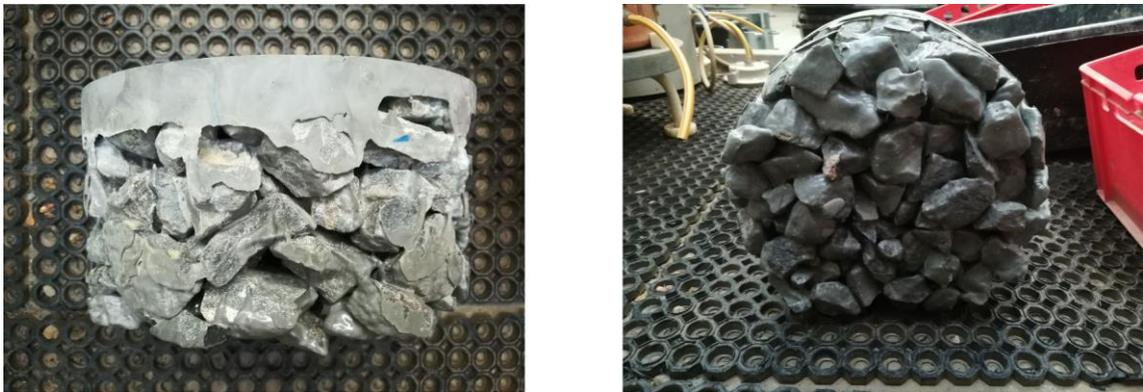
Abb. 64: Gleisschotterplatte (GSP)
