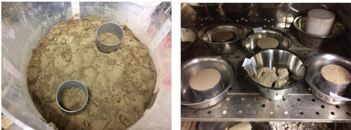
Abb. 94: Links: Probenentnahme mittels Stechzylinder nach Versuchsende; rechts: Trocknung der Probe im Ofen zur Bestimmung der Trockendichte
