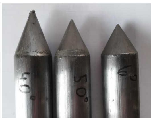
Abbildung 60: 15 cm 2 Spitzen mit Öffnungswinkel von 40°, 50° und 60° (v.l.n.r.) nach Verwendung
