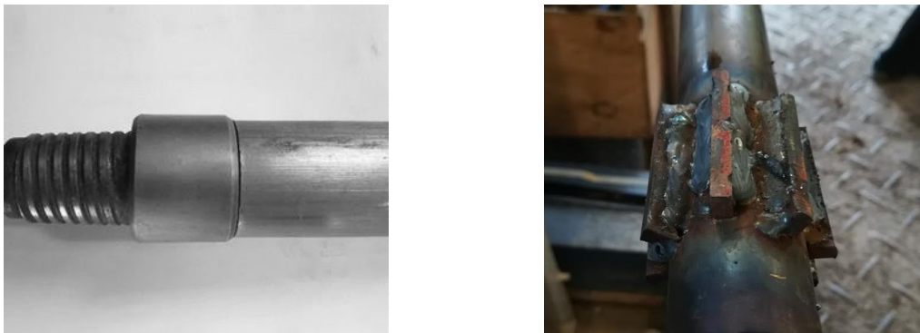
Abbildung 14: Reibungsminderer: Hülse von Pagani (links) und 8 Stege um Gestänge (rechts) (von Premstaller Geotechnik ZT-GmbH)
