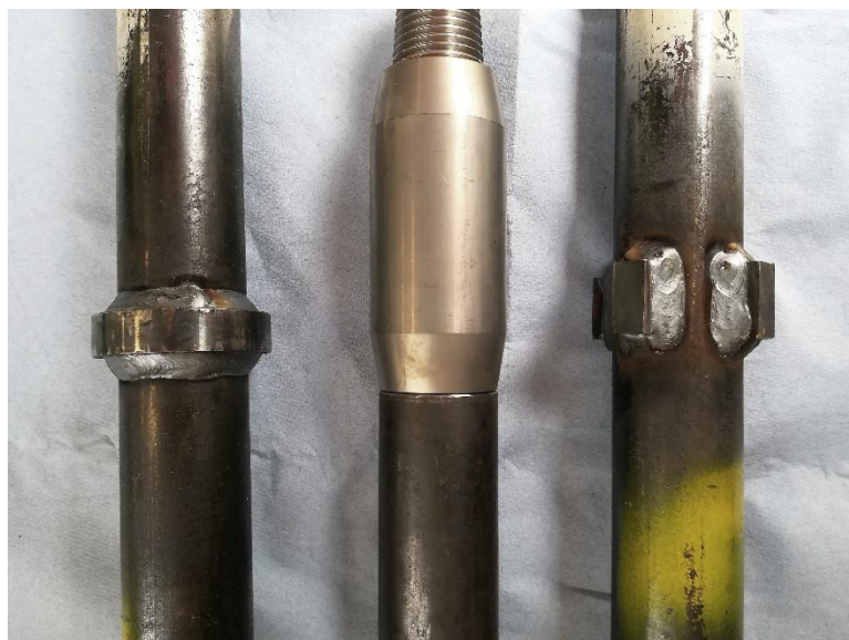
Abbildung 5: Ring, Hülse und Stege (4 Stück um Querschnitt) als Reibungsminderer (Reibungsminderer von Premstaller Geotechnik ZT-GmbH)
