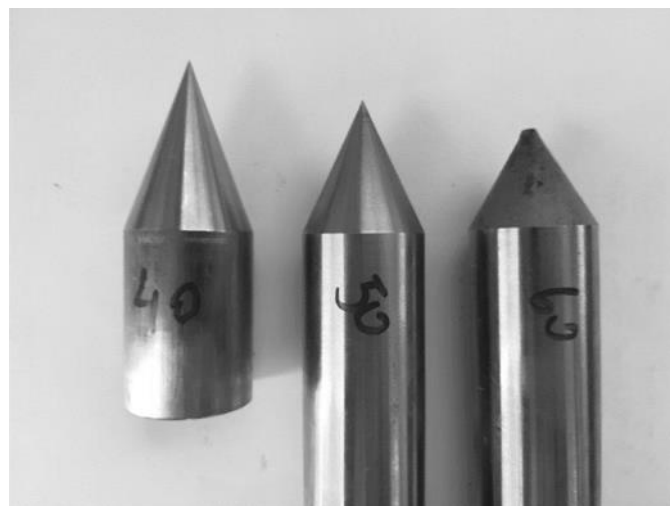
Abbildung 13: 10 cm 2 Spitzen mit Öffnungswinkel von 40°, 50° und 60° (v.l.n.r.)
