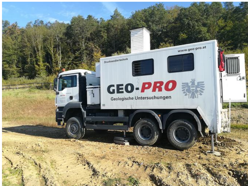
Abbildung 11: Messfahrzeug (von Premstaller Geotechnik ZT-GmbH) für CPT- und SDMT-Sondierungen
