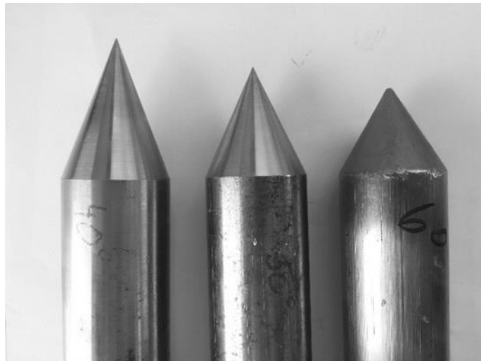
Abbildung 12: 15 cm 2 Spitzen mit Öffnungswinkel von 40°, 50° und 60° (v.l.n.r.)
