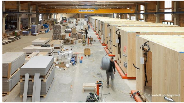
Abbildung 4.5 links: Zusammenbau der Module, rechts: Produktionslinie eines Raumzellenherstellers [36]
