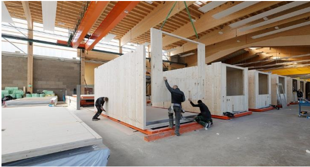
Abbildung 4.5 links: Zusammenbau der Module, rechts: Produktionslinie eines Raumzellenherstellers [36]
