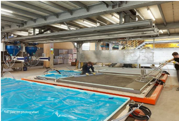
Abbildung 4.4 links: Glätten des Estrichs, rechts: Produktionslinie [36]
