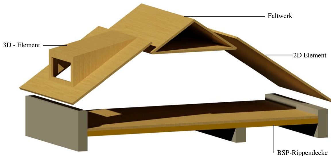
Abbildung 4.11 Explosionsdarstellung Faltwerk-Lösung, Einhängeelement als 3D-Element mit Dachgaupe
