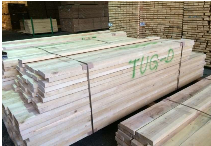
Abbildung 3-12: Foto der sortierten Brettware als Grundmaterial für die Herstellung der BSH-Prüfkörper
