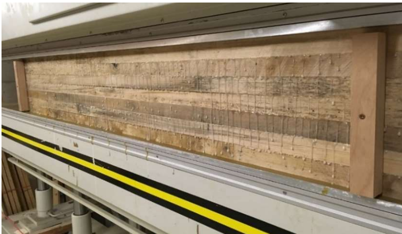
Abbildung 3-14: Träger in der Furnierpresse
