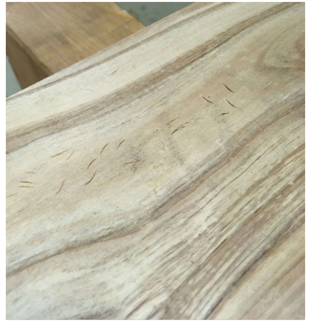
Abbildung 3-13: Bilder von aussortierten Brettern: links Kernanteil mit vielen Astlöchern; rechts Weißfäule
