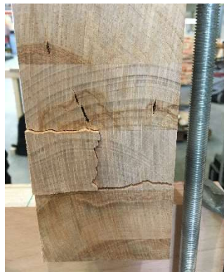
Abbildung 3-34: Schäden an den Prüfkörpern; links: Fehlstelle bei einem Ast, Mitte: Rissverlauf im Querschnitt, rechts: Auflagerpressung
