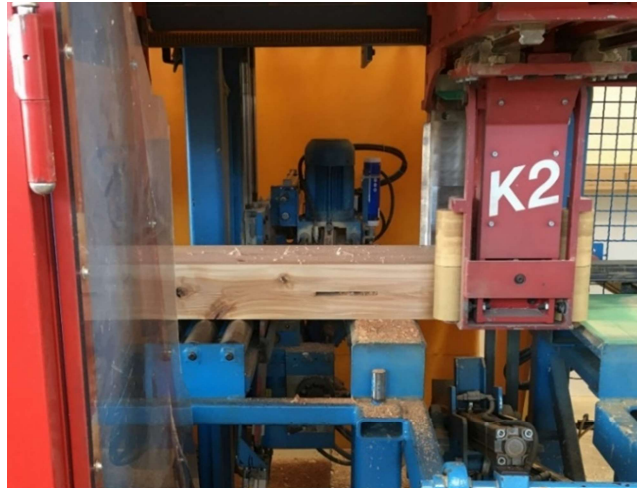
Abbildung 3-15: Schlitzfräzung der Prüfkörper mit einer Abbundmaschine
