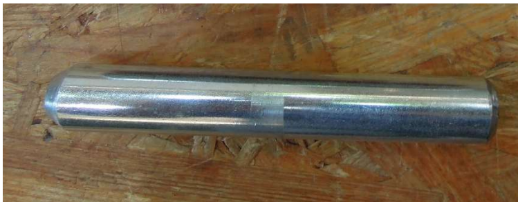
Abbildung 2-14: Bild eines im experimentellen Teil dieser Arbeit verwendeten Stabdübels
