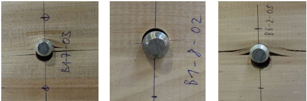
Abbildung 3-29: verschiedene Arten der Lochleibungspressung, links bei einer Schlankheit von 2,5; Mitte bei einer Schlankheit von 5,0; rechts für einen Durchmesser von 16 mm bei einer Schlankheit von 2,5
