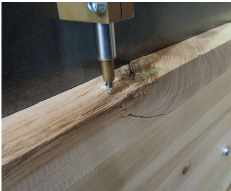
Abbildung 3-34: Schäden an den Prüfkörpern; links: Fehlstelle bei einem Ast, Mitte: Rissverlauf im Querschnitt, rechts: Auflagerpressung
