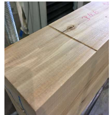
Abbildung 3-34: Schäden an den Prüfkörpern; links: Fehlstelle bei einem Ast, Mitte: Rissverlauf im Querschnitt, rechts: Auflagerpressung
