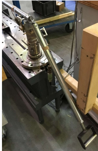
Abbildung 3-21: Prüfaufbau zur Bestimmung des Fließmoments M_y der Stabdübel
