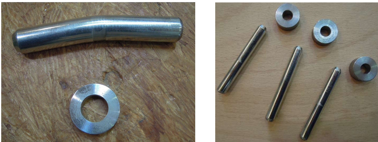
Abbildung 3-32: geprüfte Stabdübel, rechts: deformierter Stabdübel mit zugehörigem Verschleißteil, rechts: Versuch mit drei Stabdübel – nur sehr geringe Deformation erkennbar
