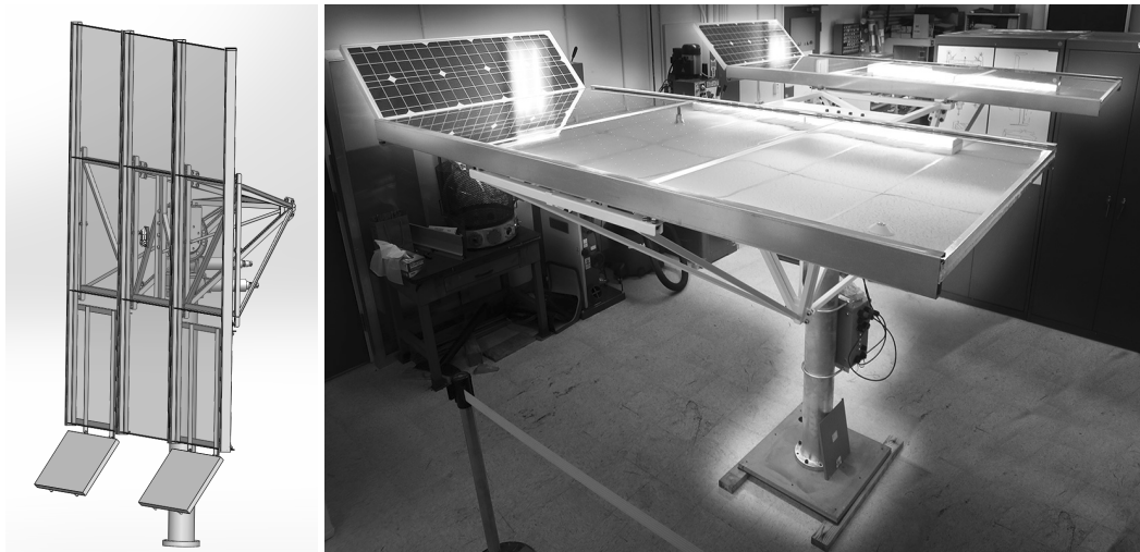
Abbildung 2: CAD-Modell und Foto des JPL Heliostat Prototypen.
