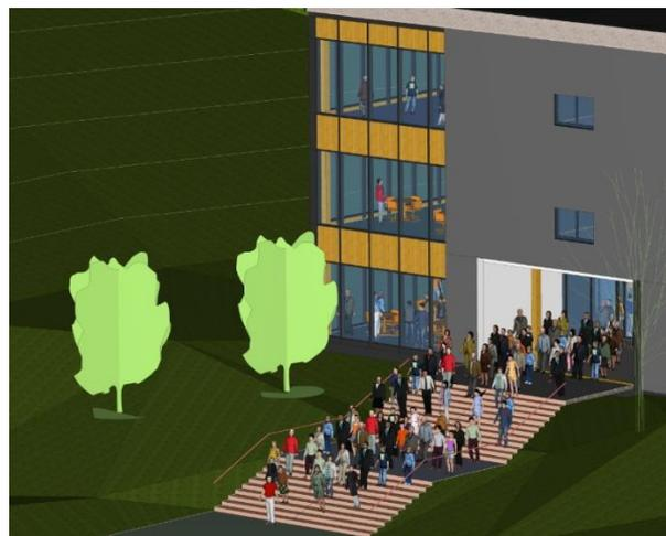
Abbildung 10: Beispiel einer Evakuierungssimulation auf Basis eines BIM-Modells
