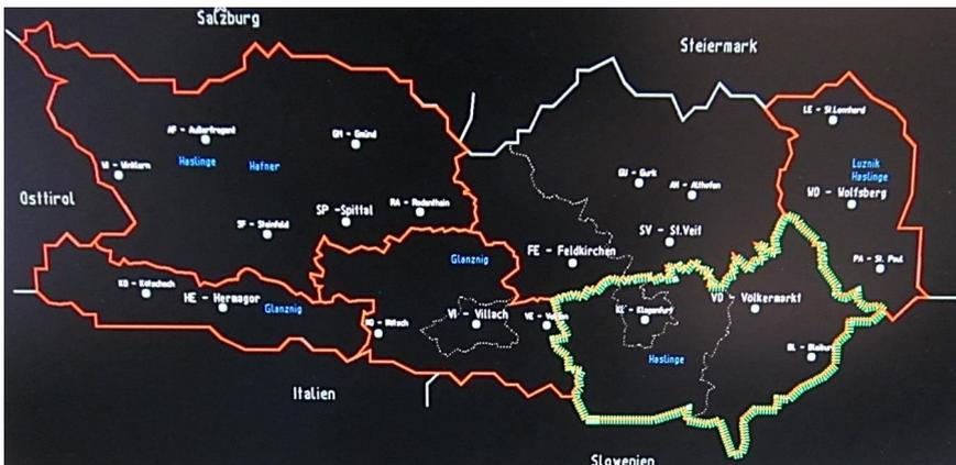
**Abbildung 3-15: Visualisierung einer Zuteilung von SCADA-Rechten auf Operatoren**
