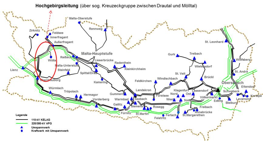
Abbildung 4-18: Hochgebirgsleitung in einem 110-kV Netz [4.52<sup>RS</sup>]
