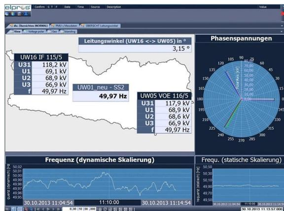
Abbildung 3-26: Einsatz von PMUs in einem Hochspannungsnetz
