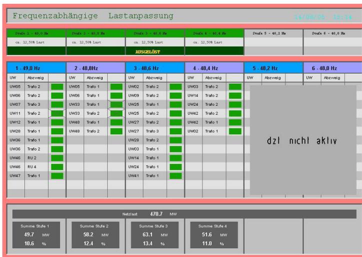
Abbildung 3-24: Visualisierung des frequenzabhängigen Lastabwurfs in SCADA
