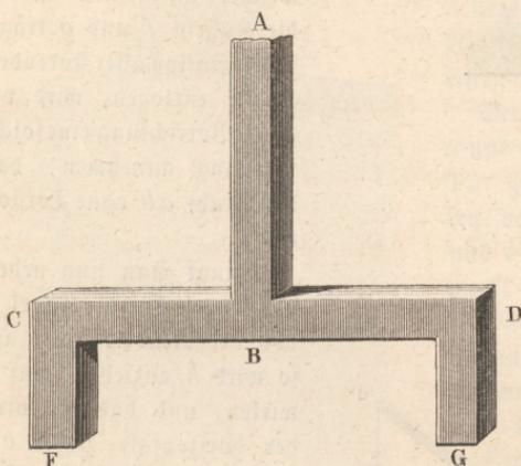
Gestalt von Fig. 148. In  $AB$  befindet sich der Aufhängerdraht,  $CD$  schließt den horizontalen Hebel ein und in den verticalen Armen  $CF$  und  $DG$  befinden sich die Kugeln  $f$  und  $g$  mit ihren Aufhängerdrähten. Das Ganze ist nur so weit, daß dem Hebel  $cd$  der nöthige Spielraum für die kleine, durch  $h$  hervorgebrachte Ablenkung und die kleinen Schwingungen bleibt.
