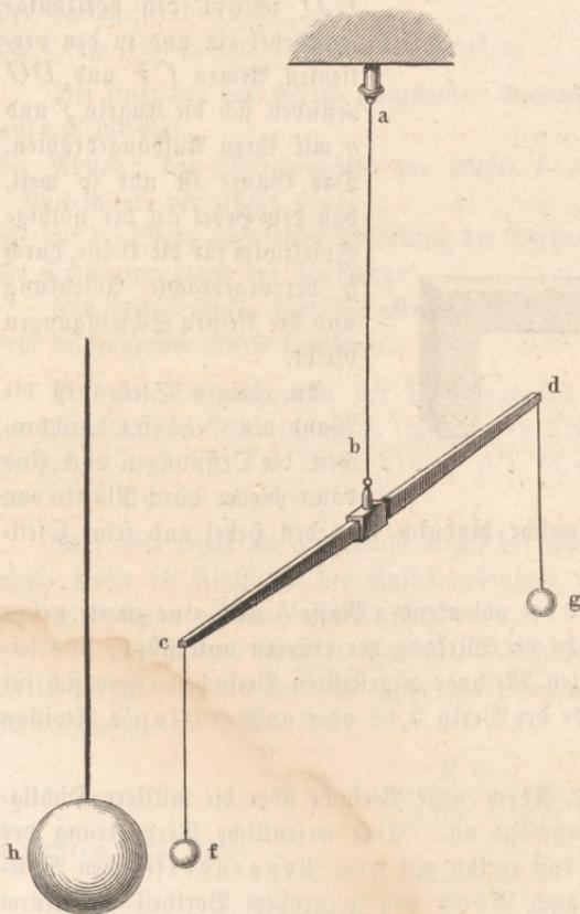
gleicharmiger Hebel *cd*, welcher an seinen Enden die Kugeln *f* und *g* trägt. Dem Einfluß aller störenden Kräfte entzogen, wird die ganze Vorrichtung eine solche Stellung annehmen, daß der Draht *ab* ohne Torsion ist.
