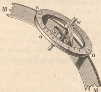
welche den einzelnen Stunden entsprechen. Die Theilstriche bei *s* und *n* sind mit 12 bezeichnet und dann die Stunden von *s* über *w* bis *n* und von *n* über *o* bis *s* gezählt.
