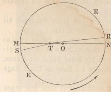
Wenn die Sonne mit gleichförmiger Geschwindigkeit den Kreis EE', Fig. 56, durchläuft, die Erde sich aber in T außerhalb des Kreismittelpunktes O befindet, so wird die Bewegung der Sonne, von der Erde aus gesehen, nicht mehr gleichförmig erscheinen; denn wenn auch die gleichen Bogen NR und MS von der Sonne in gleichen Zeiten durchlaufen werden, so sind doch die Winkel, unter welchen diese Bogen, von T aus gesehen, erscheinen, nicht gleich,
