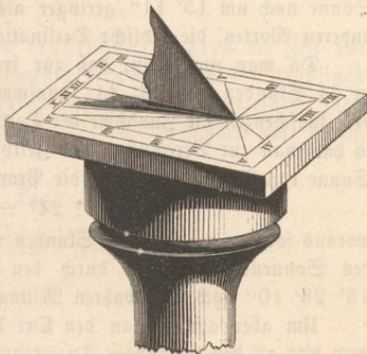
Bei kleinen Sonnenuhren ist häufig der schattengebende Stab durch eine verticale Metallplatte ersetzt, deren oberer geradliniger Rand die Richtung der Weltaxe hat. Fig. 52 stellt eine derartige kleine Sonnenuhr mit horizontalem Zifferblatte dar.
