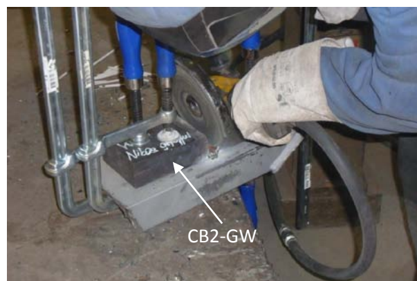
Abbildung 4.2 Abarbeiten von Schlacke und Unebenheiten der Nickelbasis-Pufferlagen am CB2.
