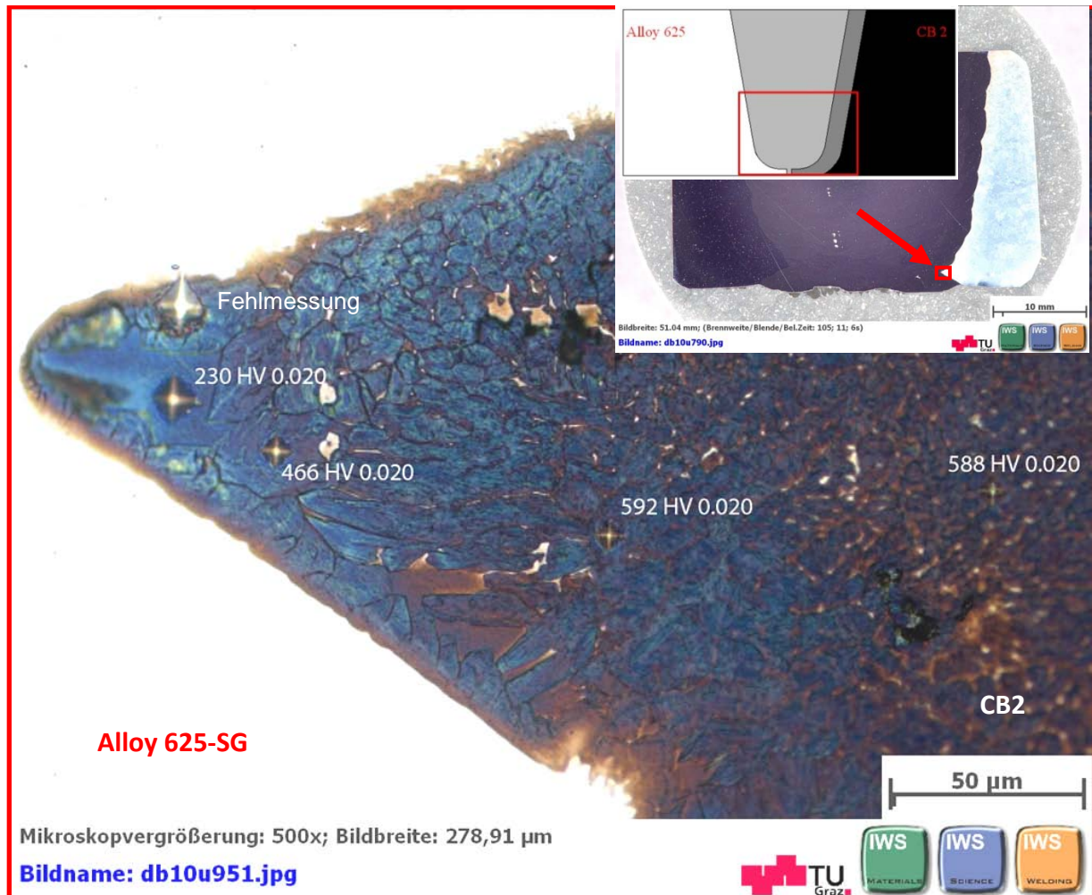
Abbildung 4.13 Mikrohärtemessungen der WEZ der Wurzel des CB2; Stabelektrode (2. Probe), Ätzung: mod. LB II.
