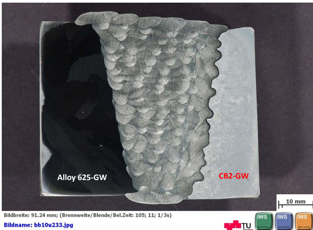
Abbildung 4.8 Nahtaufbau Schweißung mit Stabelektrode (2. Probe, Ätzung: Nr.3).
