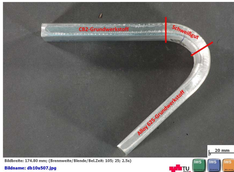
Abbildung 4.63 Gebogene Seitenbiegeprobe (1. Schweißung - Stabelektroden).
