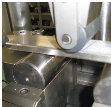
Abbildung 4.62 3-Punkt-Biegeprüfung der ersten Probeschweißung (Stabelektroden-Schweißung).
