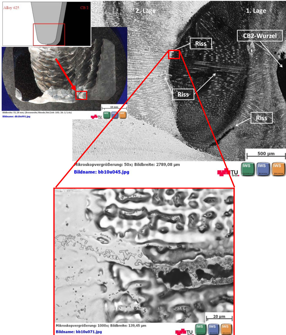
Abbildung 4.22 Riss im Bereich um die Wurzel; Fülldrahtelektrode (4. Probe), Ätzung: Königswasser.
