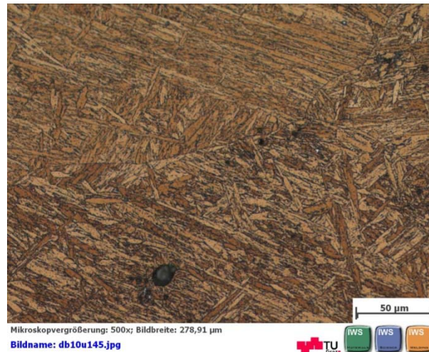
Abbildung 4.6 Grundwerkstoff CB2; Ätzung: mod. LB II.
