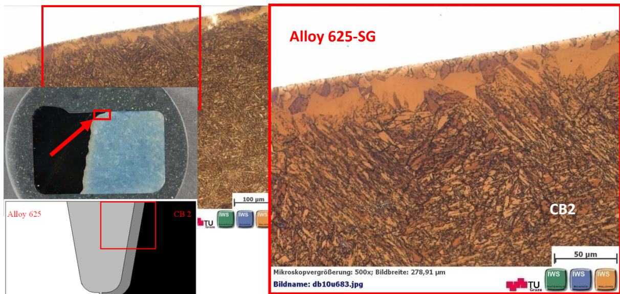
Abbildung 4.18 WEZ der Decklage des CB2; Fülldrahtelektrode (4. Probe), Ätzung: mod. LBII.
