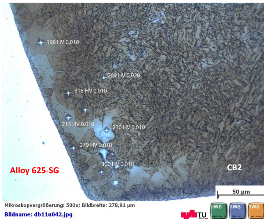
Abbildung 11.7 Mikrohärtemessungen der WEZ der Flanke des CB2; Massivdrahtelektrode (2. Probe), Ätzung: mod. LB II).
