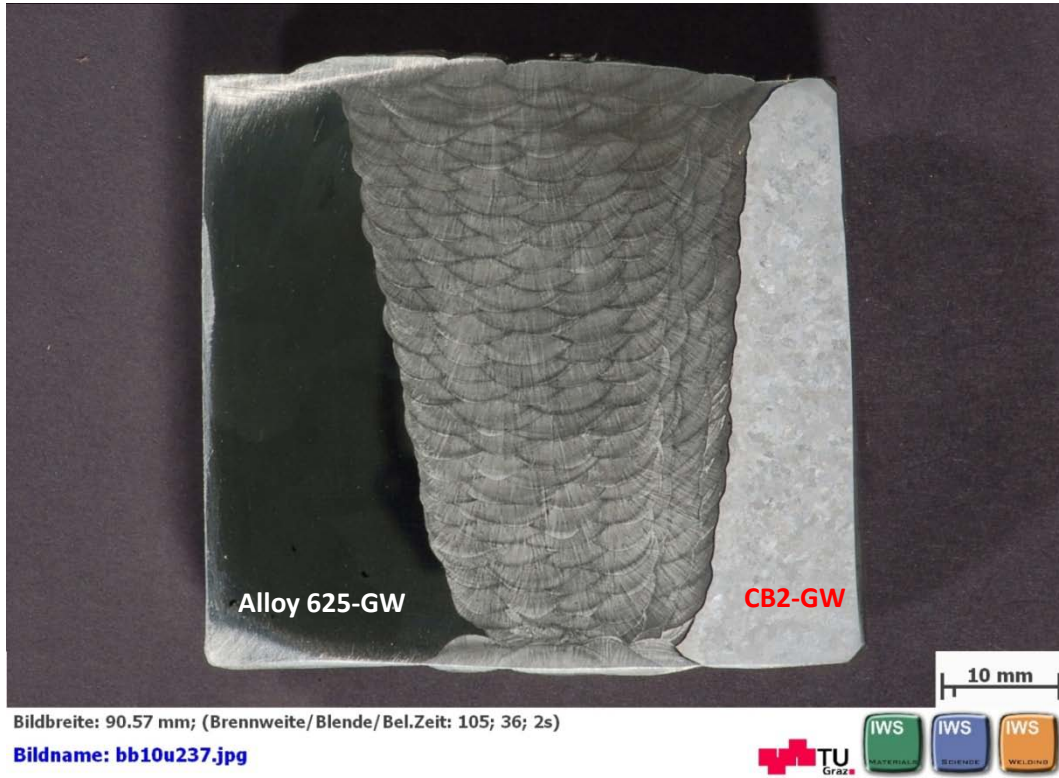
Abbildung 4.8 Nahtaufbau Schweißung mit Stabelektrode (2. Probe, Ätzung: Nr.3).
