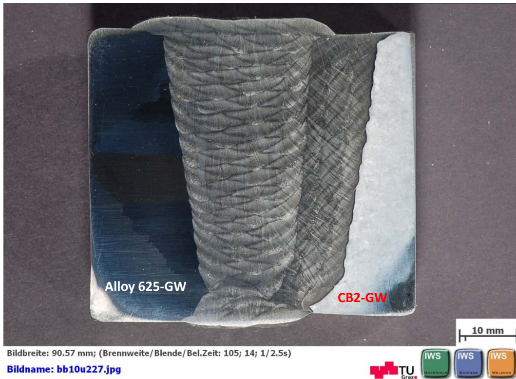
Abbildung 4.10 Nahtaufbau Schweißung mit Fülldrahtelektrode (4. Probe, Ätzung: Nr. 3).
