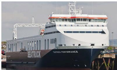
(e) SEATRUCK PERFORMANCE. RoRo-Schiff, 2.166 Spurmeter auf 4 Decks. Im April 2012 von der FSG geliefert.
