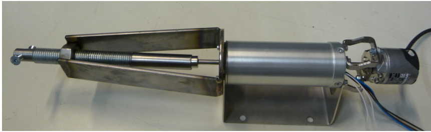
Abbildung 1.1.: Asynchronmaschine „E-Steller Version 2“ der Firma Kristl, Seibt & Co. GmbH.
